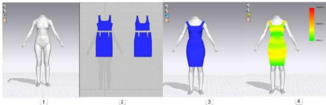
Sl.16. Proces virtualnog oblikovanja odjeće i testiranja odjeće odgovara: 1) uvozu 3D modela tijela; 2) dizajn odjeće; 3) ogrtać odjeće; 4) ispitivanje prikladnosti odjeće[19]
