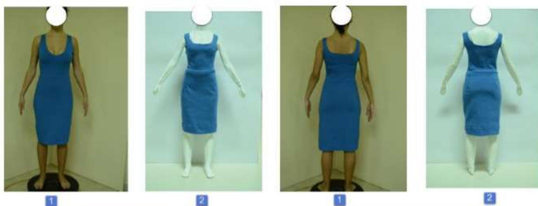
Sl.20. Ispitivanje odjeće odgovara stvarnom modelu tijela i skaliranom 3D tiskanom modelu tijela[19]
