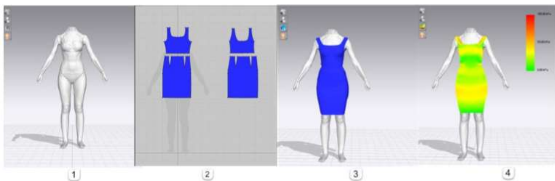
Sl.16. Proces virtualnog oblikovanja odjeće i testiranja odjeće odgovara: 1) uvozu 3D modela tijela; 2) dizajn odjeće; 3) ogrtač odjeće; 4) ispitivanje prikladnosti odjeće[19]
