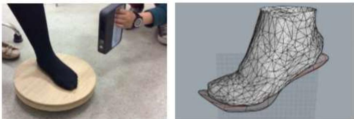
Sl.9. (lijevo) 3D skeniranje; (desno) 3D modeliranje [12]
