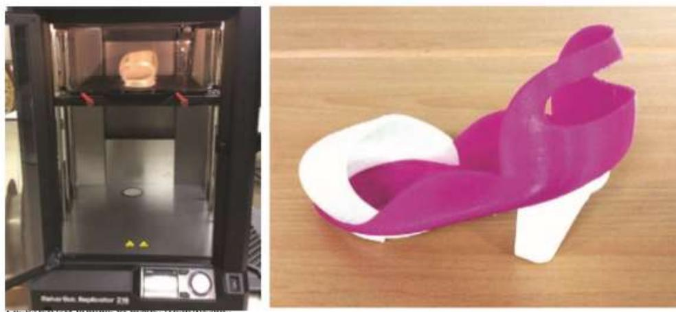
Sl.10. Prototipovi cipela i testiranje [12]
