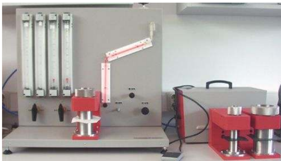
Sl. 25. Uređaj za ispitivanje propusnosti zraka tt. SDL Atlas
