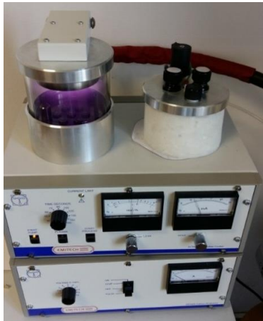
Slika 23. a) Naparivač uzoraka CS7620, Qourum Technologies (Velika Britanija), b) proces naparivanja uzoraka
