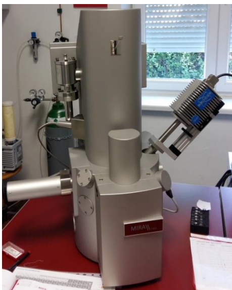
Slika 24. a) FE-SEM mikroskop, tt. Tescan, MIRA\\LMU, Češka; b) komora mikroskopa
