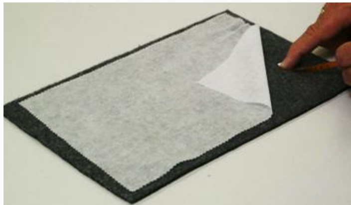
Sl.27 Postavljanje međupodstave na osnovni materijal i listića za provjeru temperature frontalnog fiksiranja [26]
