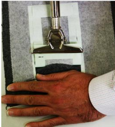
Sl.33 Postupak provjere čvrstoće spoja [26]
