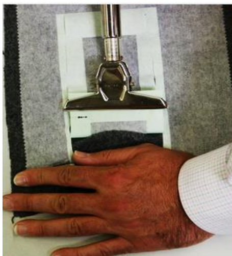
Sl.33 Postupak provjere čvrstoće spoja [26]
