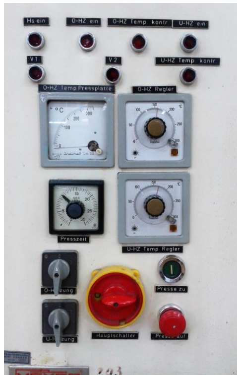
Sl.23 Dio stroja za frontalno fiksiranje tt. Herbert Meyer na kojem se podešavaju parametri frontalnog fiksiranja
