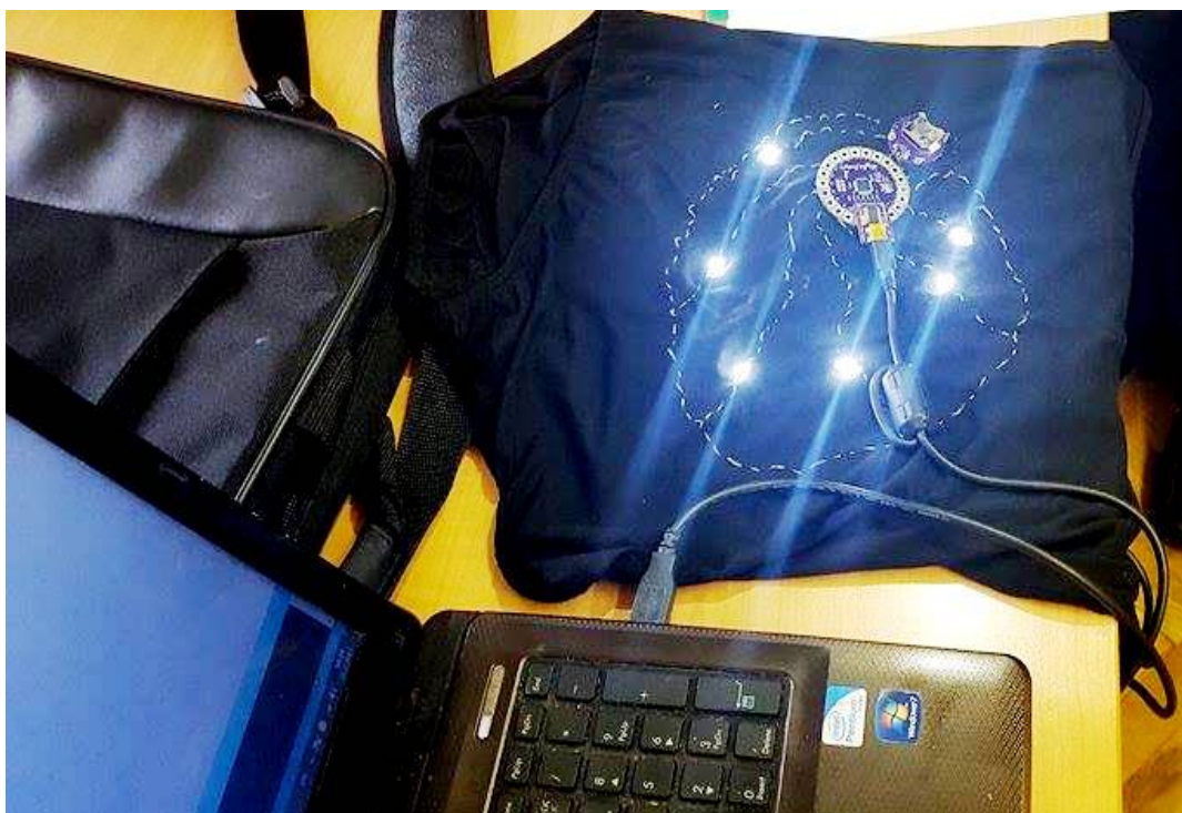
Sl. 30 Prebacivanje programa na LilyPad i probni rad programa
