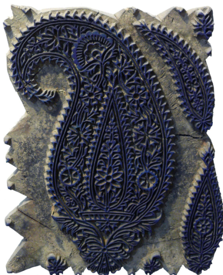
Slika 19: Drveni pečat za izradu Paisley uzorka na tekstu
