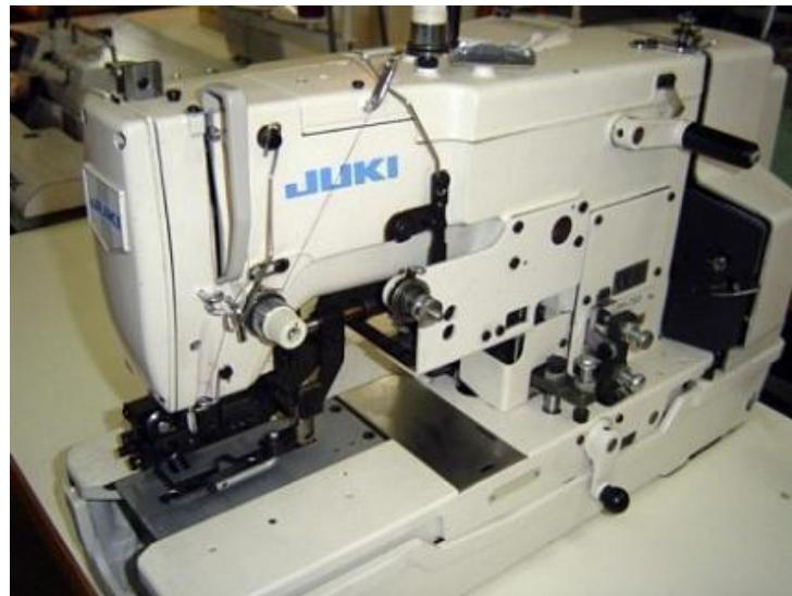
Sl.6. Šivaći agregat za izradu rupica [10]
