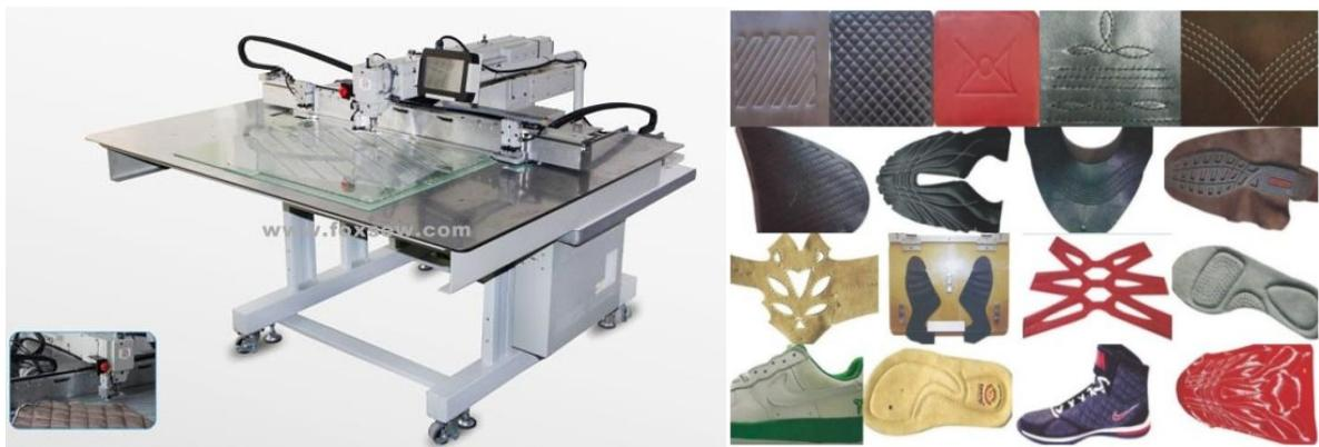
Sl. 29. Programabilni šivaći stroj za šivanje uzorka [23]
