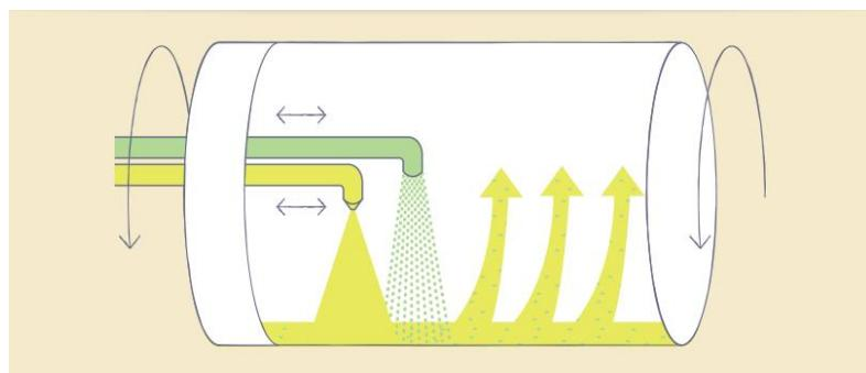
**Slika 2.1.2.2.7.** Centrifugalno lijevanje [11].
