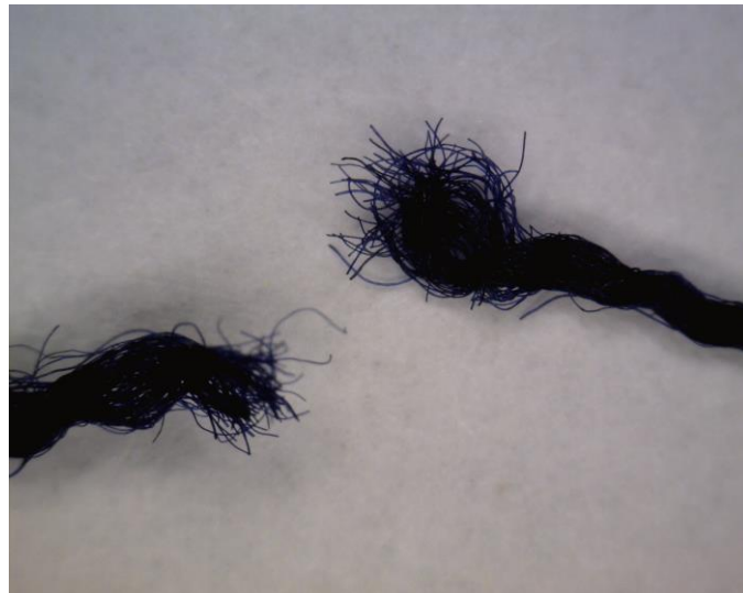
SI. 26. Prekinuta nit pređe izvađene iz tkanine
