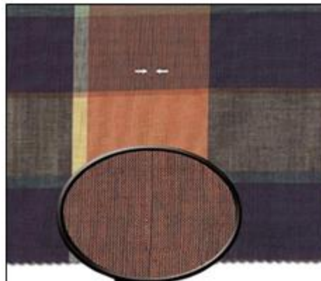
Sl. 5. Pogreška u tkanini radi oštećenja brda [8]
