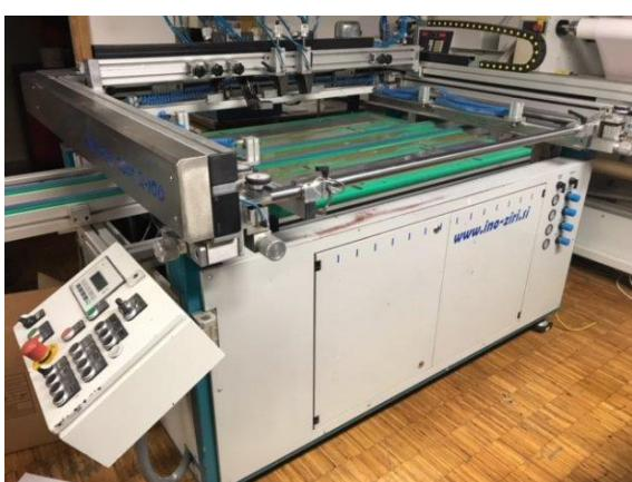
Slika 36. Automatski tiskarski stroj
