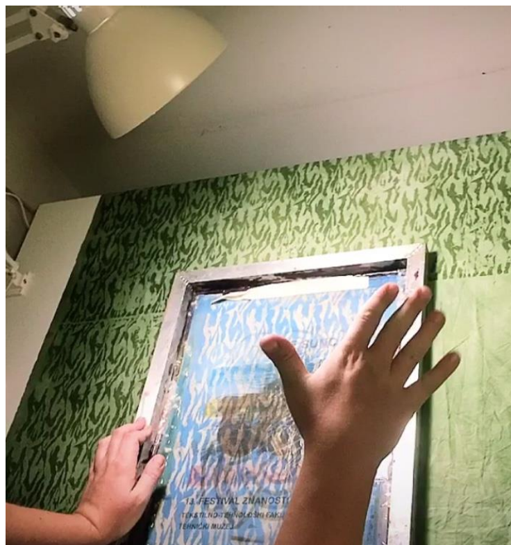
Sl.17. Postupak ručnog tiska jetkanjem[16]
