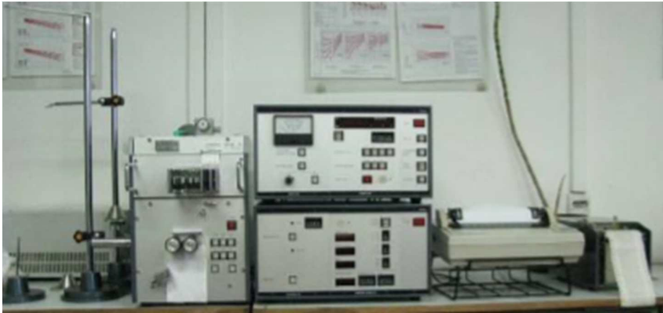
Slika 8. Uređaj za ispitivanje nejednolikosti tt. Keisokki
