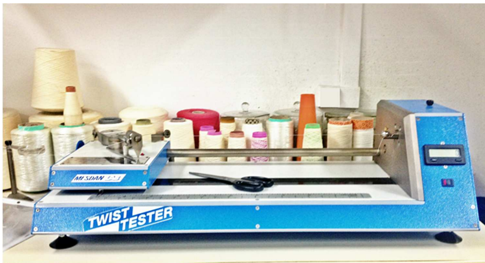
Slika 7. Torziometar marke Twister, Mesdan Lab, Italija
