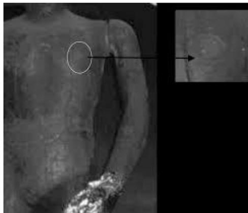
Sl. 22. Prikaz senzora na tijelu požarne lutke [47]
