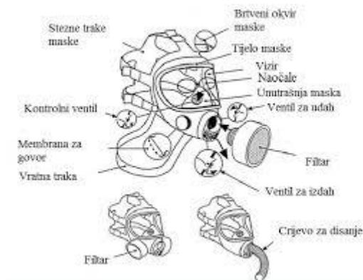
Sl. 1. Dijelovi maske za cijelo lice [8]
