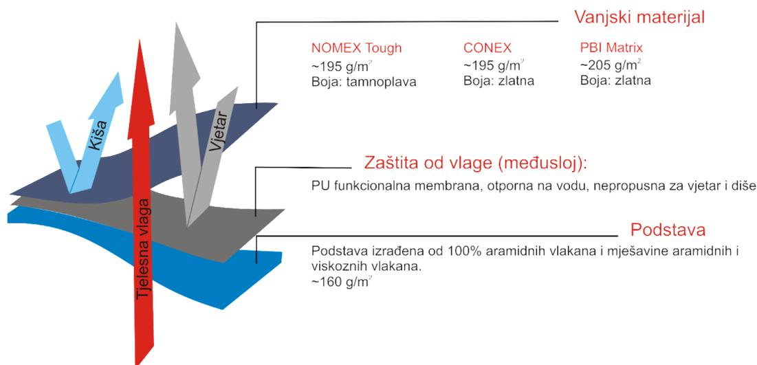
Sl. 14. Shematski prikaz slojeva zaštitne vatrogasne odjeće i najčešće upotrebljavani materijali [37]
