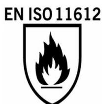
Sl. 8. Piktogram zaštitne odjeće za zaštitu od topline i plamenaprema normu ISO 11612 [18]
