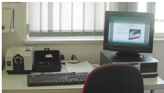
Slika 13: Remisijski spektrofotometar Spectraflash SF 300, tt. Datacolor
