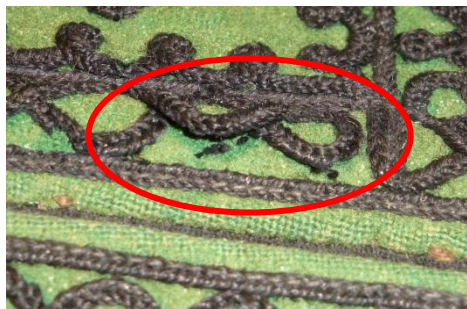
Slika 33: Pozamenterijska traka: a) prekidi pozamenterijske na prednjoj strani prsluka, b) prekidi pozamenterijske trake na leđima prsluka, c) prekid šavova koji spajaju pozamenterijsku traku za osnovnu tkaninu
