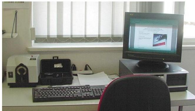
Slika 13: Remisijski spektrofotometar Spectraflash SF 300, tt. Datacolor
