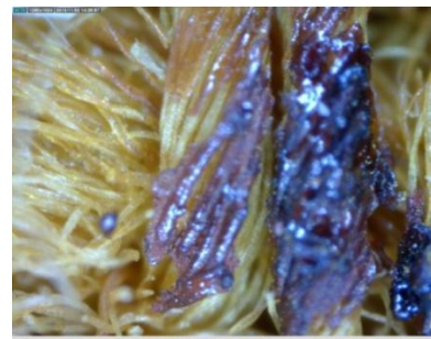
Slika 40: Mikroskopska slika smolaste mrlje
