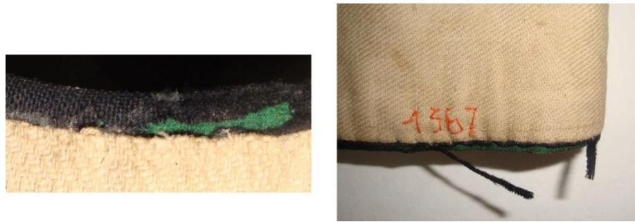
Slika 41: Paspul traka; a) oštećenje u obliku otvora na traci, b) oštećenje u obliku prekida trake
