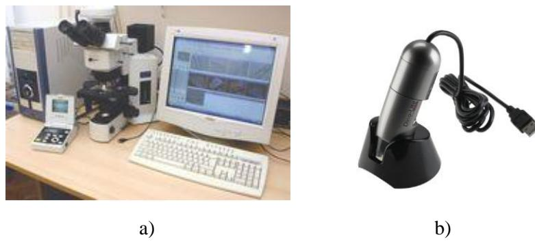
Slika 12: Uređaji korišteni za mikroskopska ispitivanja: a) Olympus BX51, b) Dino-Lite
