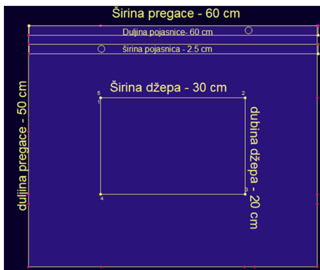
Slika 32 Konstrukcija temeljnog kroja ugostiteljske pregače
