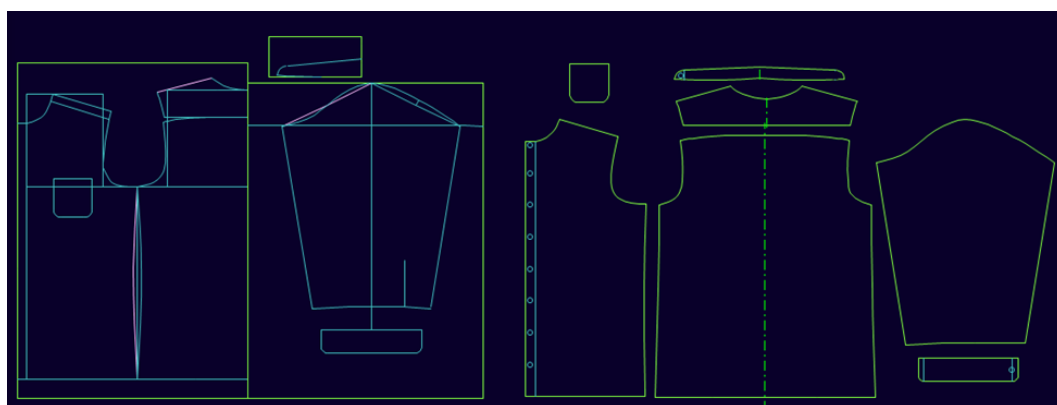
Slika 30 Temeljna konstrukcija muške košulje
