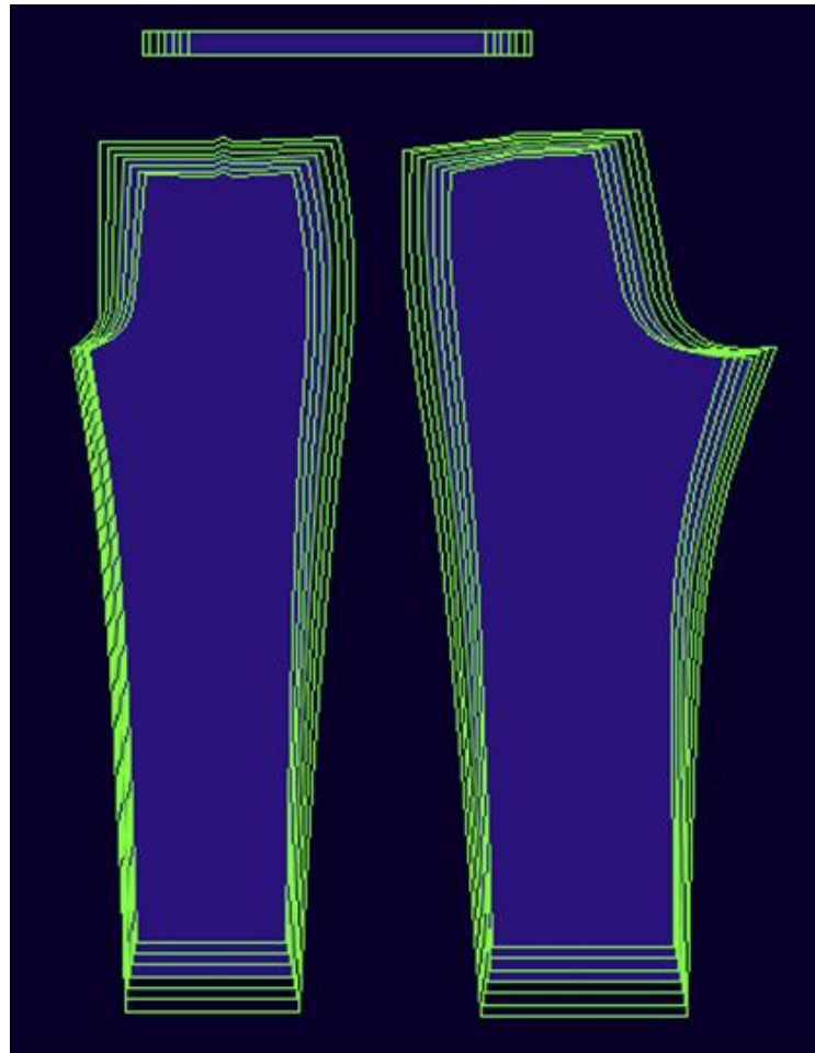
Slika 69 Rezultati gradiranja muških hlača
