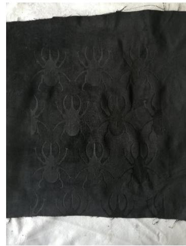
Uzorak 9: Pliš materijal - pigmentna tiskarska pasta
