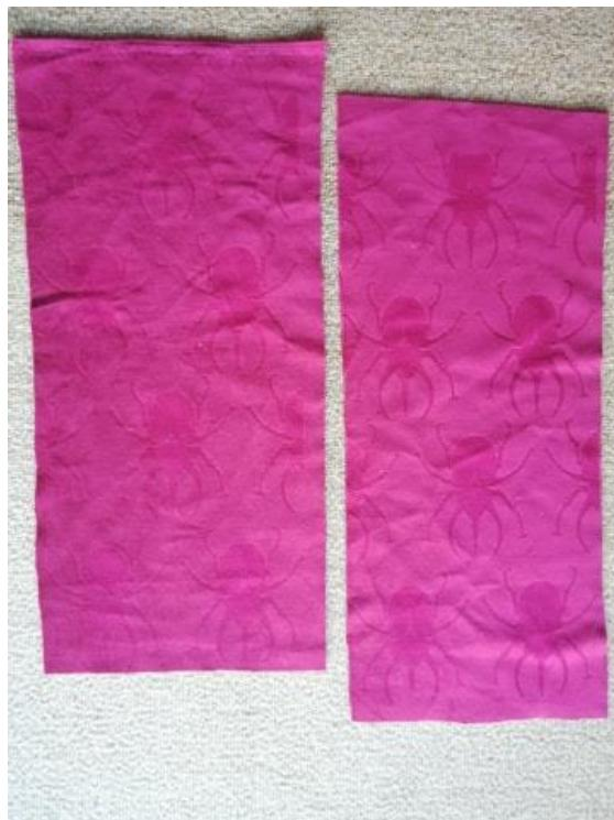
Uzorak 13: temeljna tiskarska pasta (lijevo) i pigmentna tiskarska pasta (desno)
