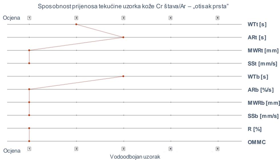
**Slika 39.** Grafički prikaz sposobnosti prijenosa tekućine kod uzorka kromno štavljenje kože uz predobradu Ar plazmom; tzv. „otisak prsta“ (engl. Finger print)
