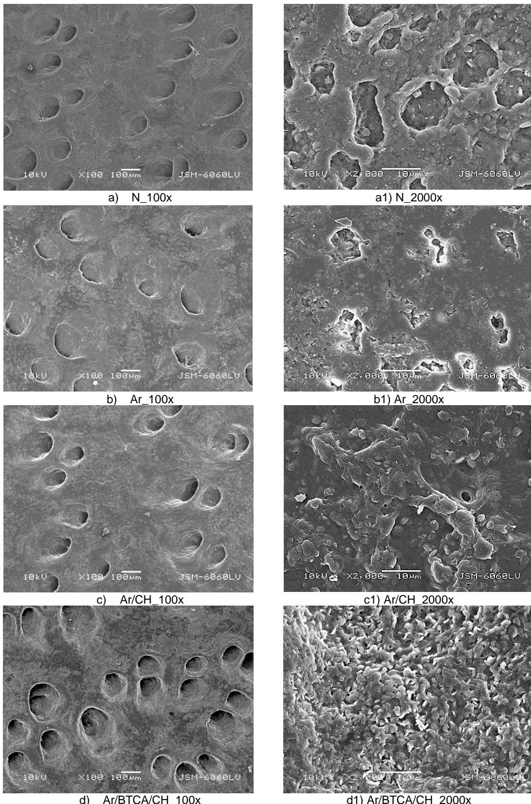
**Slika 54.** SEM snimke vegetabilno štavljene kože uz povećanje 100x i 2000x: a) i a1) neobrađeni uzorak; b) i b1) kisikova plazma; c) i c1) obrada O<sub>2</sub>/BTCA; d) i d1) obrada O<sub>2</sub>/BTCA/CH
