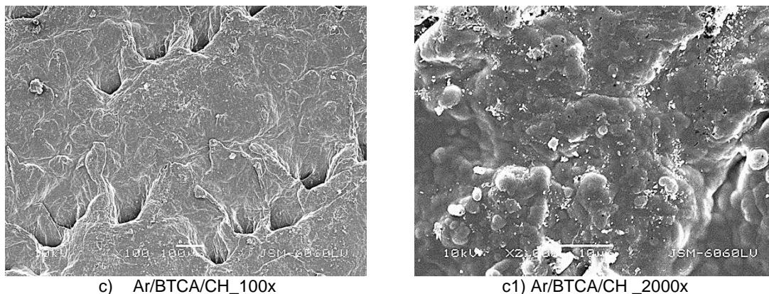
**Slika 49.** SEM snimke kromno štavljenog uzorka kože uz povećanja 100x i 2000x: a) i a1) argonova plazma; b) i b1) obrada Ar/CH; c) i c1) obrada Ar/BTCA/CH
