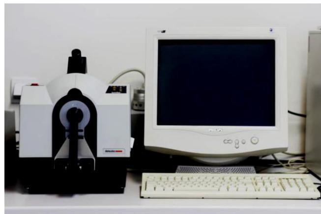
**Slika 34.** Remisijski spektrofotometar DataColor SP600+ CV UV [81]
