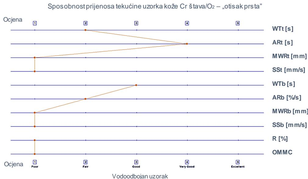
**Slika 41.** Grafički prikaz sposobnosti prijenosa tekućine код узорка кромно штављене коže уз предобраду O<sub>2</sub> плазмом; tzv. „отисак прста“ (engl. Finger print)
