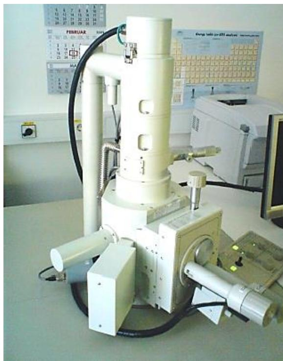
**Slika 31.** Prikaz pretražnog elektronskog mikroskopa, Jeol LV-6060 [80]
