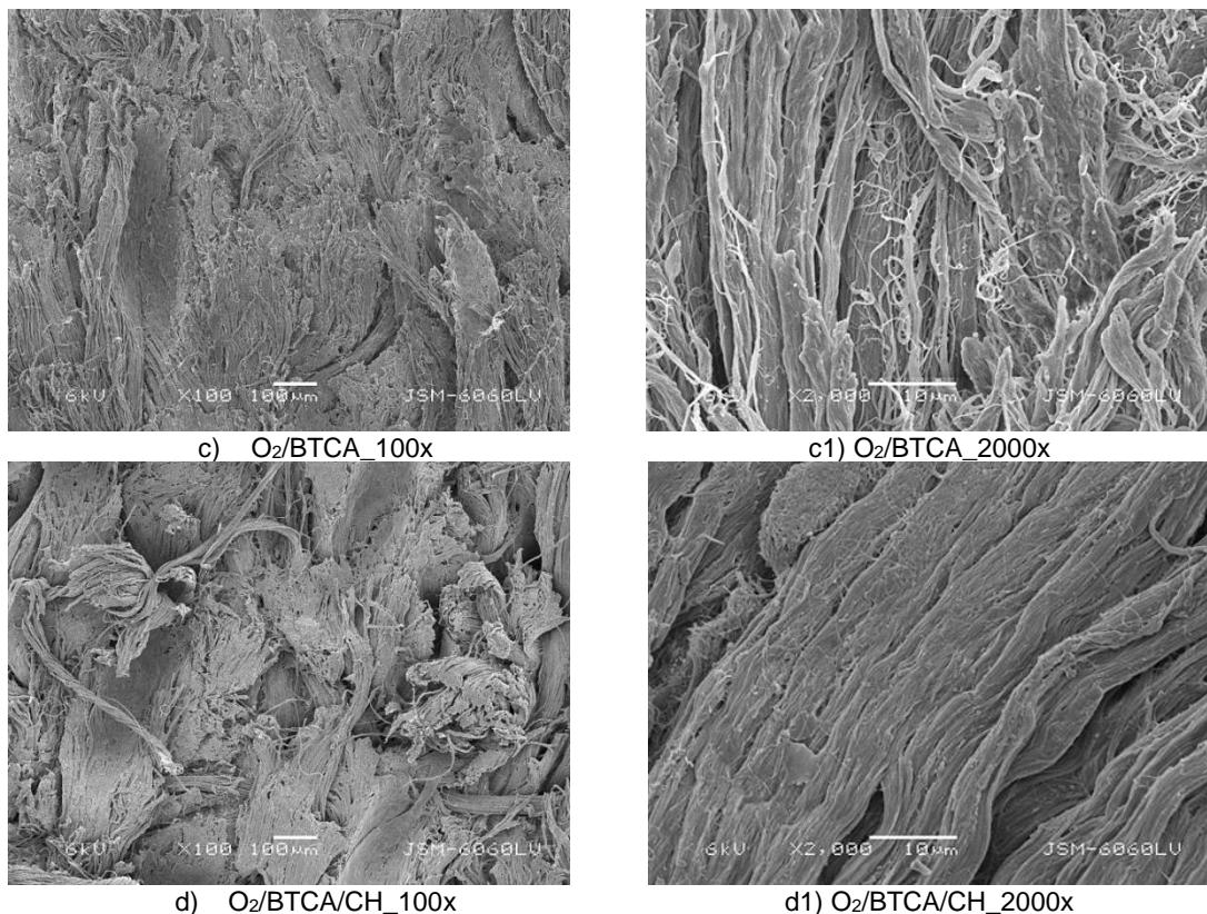
**Slika 50.** SEM snimke cjepanika(Cr štava)uz povećanja 100x i 2000x: a) i a1) neobrađeni uzorak; b) i b1) kisikova plazma; c) i c1) obrada O<sub>2</sub>/BTCA; d) i d1) obrada O<sub>2</sub>/BTCA/CH
