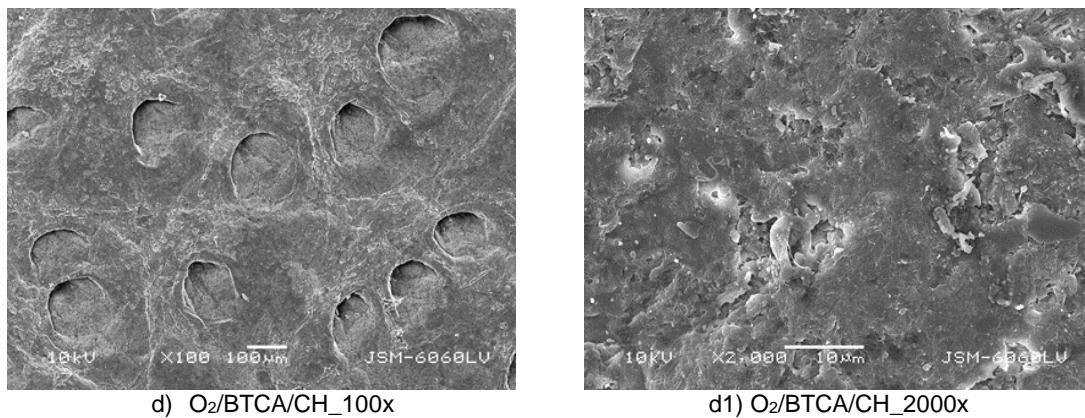
**Slika 48.** SEM snimke kromno štavljene kože uz povećanja 100x i 2000x: a) i a1) neobrađeni uzorak; b) i b1) kisikova plazma; c) i c1) obrada O<sub>2</sub>/BTCA; d) i d1) obrada O<sub>2</sub>/BTCA/CH
