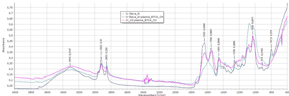
**Slika 56.** Apsorpcijski FTIR spektri kromno štavljenog uzorka prije i nakon obrade s  $\text{O}_2$  ili Ar/BTCA/CH
