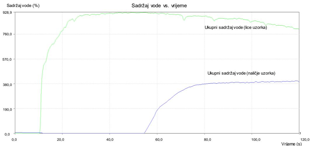
**Slika 46.** Grafički prikaz ukupnog sadržaja vode u vremenu na licu i naličju uzorka sintetski (Cr free) štavljeni kože uz predobradu O<sub>2</sub> plazmom
