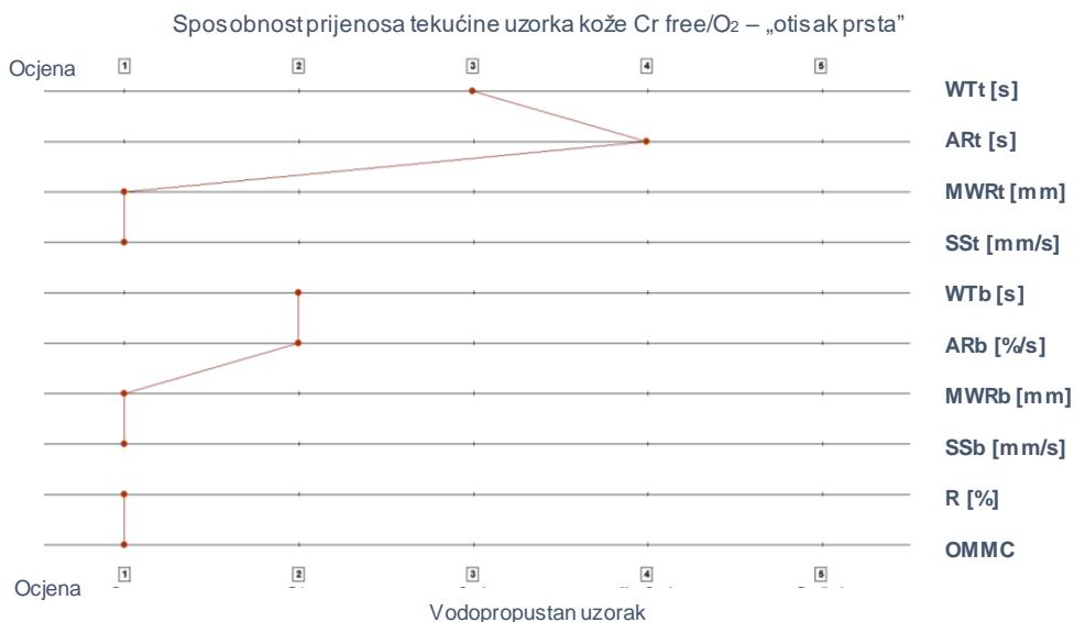
**Slika 47.** Grafički prikaz sposobnosti prijenosa tekućine kod uzorka sintetski (Cr free) štavljeni kože uz predobradu O<sub>2</sub> plazmom; tzv. „otisak prsta“ (engl. Finger print)
