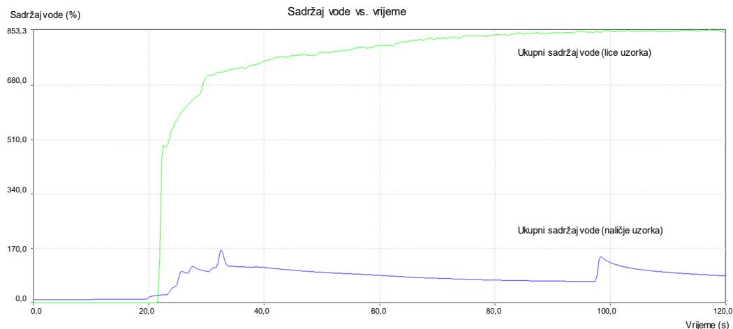
**Slika 38.** Grafički prikaz ukupnog sadržaja vode u vremenu na licu i naličju uzorka kromno štavljenje kože uz predobradu Ar plazmom
