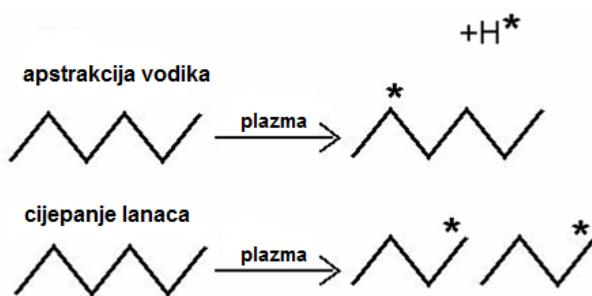
Slika 4. Shematski prikaz procesa čišćenja plazmom [17]
