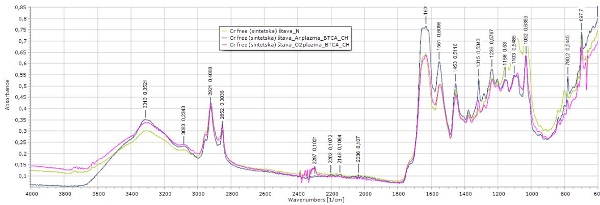
**Slika 58.** Apsorpcijski FTIR spektri sintetski štavljenog uzorka prije i nakon obrade s  $O_2$  ili Ar/BTCA/CH
