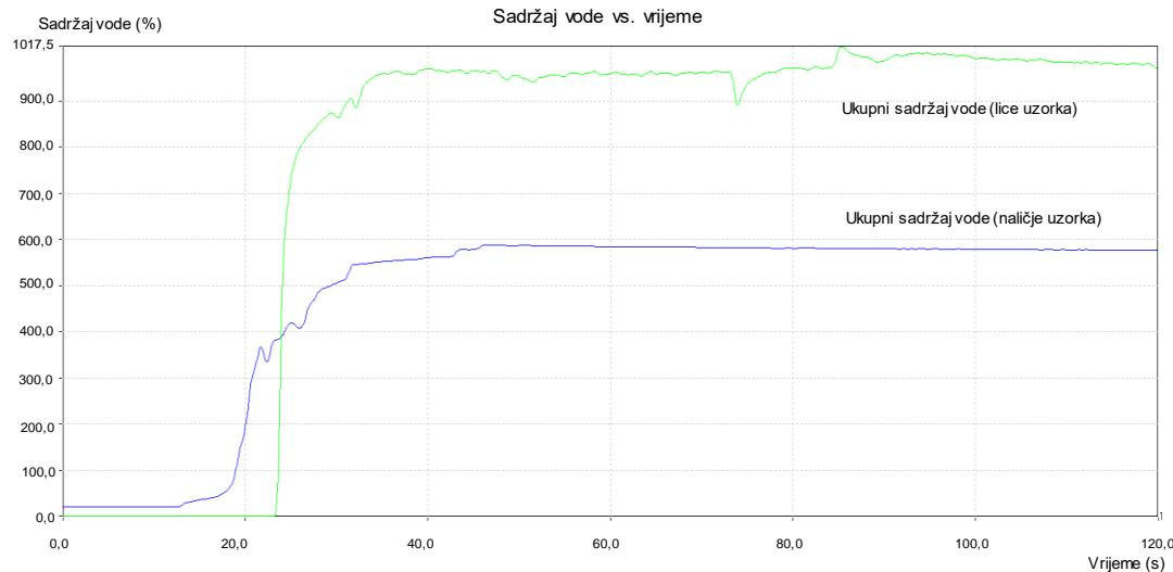
**Slika 40.** Grafički prikaz ukupnog sadržaja vode u vremenu na licu i naličju uzorka kromno štavljenje kože uz predobradu O<sub>2</sub> plazmom
