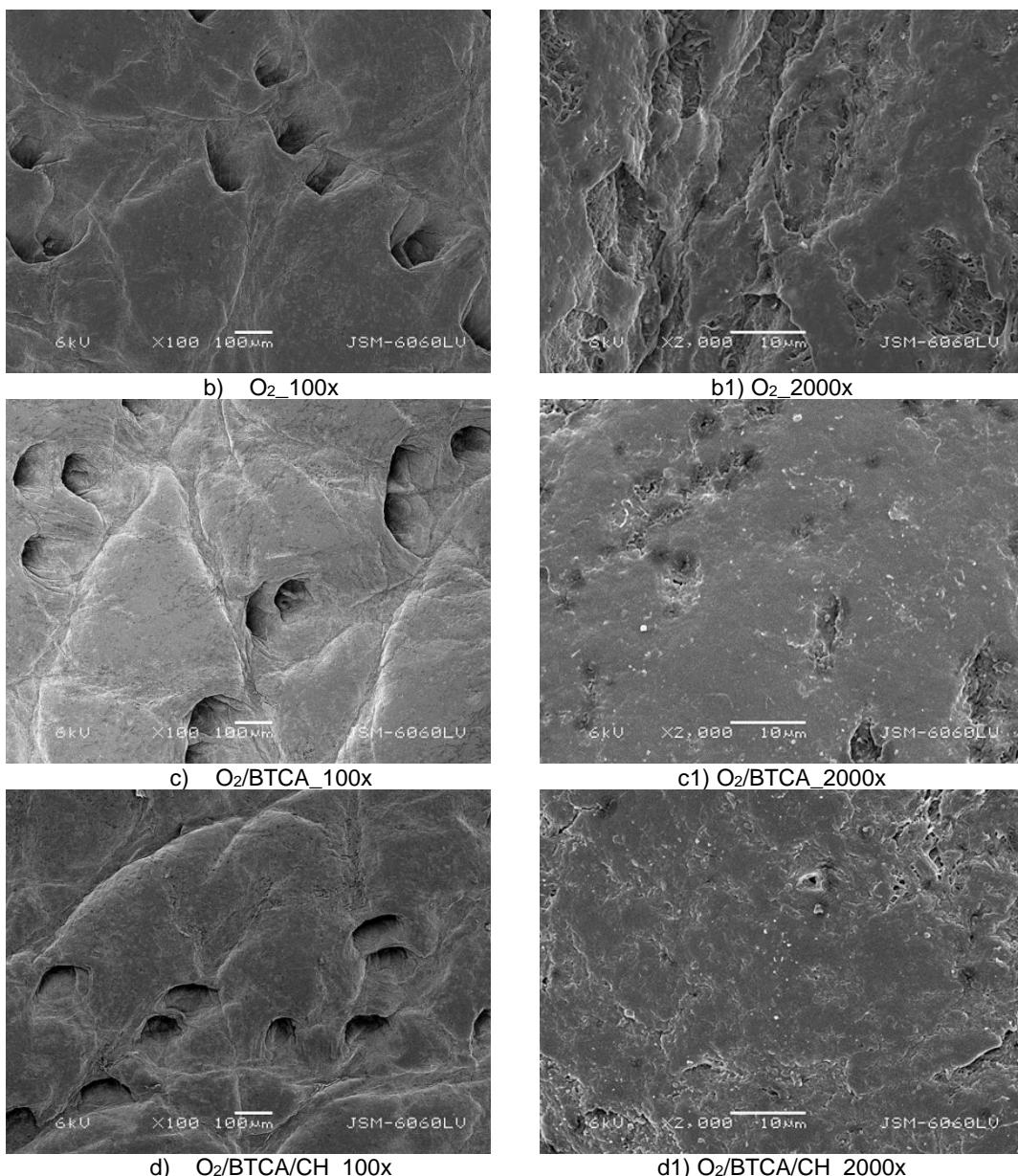
**Slika 52.** SEM snimke sintetski štavljenje kože uz povećanja 100x i 2000x: a) i a1) neobrađeni uzorak; b) i b1) kisikova plazma; c) i c1) obrada  $O_2$ /BTCA; d) i d1) obrada  $O_2$ /BTCA/CH
