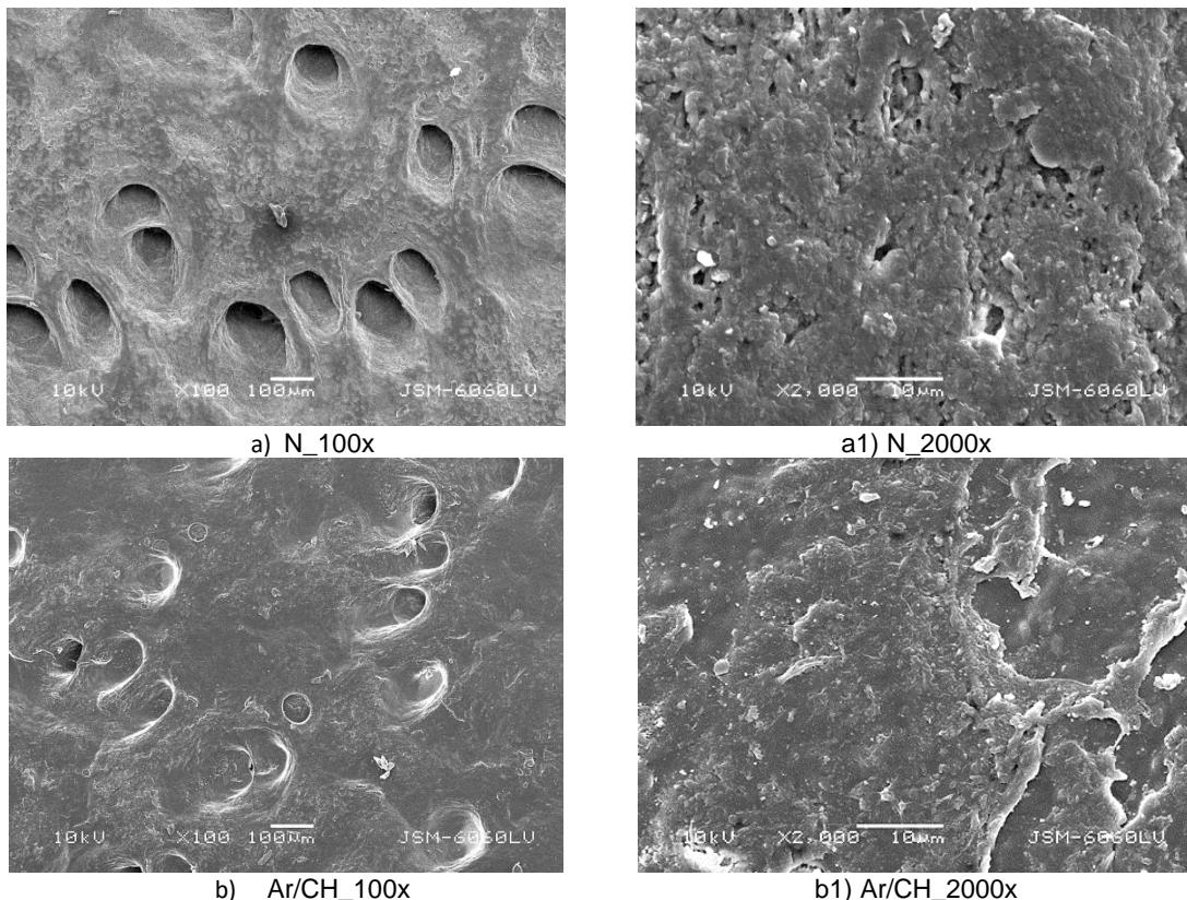
**Slika 55.** SEM snimke vegetabilno štavljenje kože nakon močenja u alkalnoj otopini znoja, uz povećanja 100x i 2000x: a) i a1) neobrađeni uzorak; b) i b1) obrada Ar/CH
