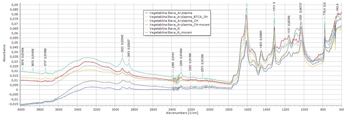
**Slika 59.** Apsorpcijski FTIR spektri vegetabilno štavljenog uzorka prije i nakon različitih obrada
