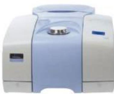
**Slika 32.** FTIR spektrofotometar Spectrum 100S FTIR-ATR, Perkin Elmer [73]
