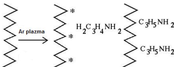
**Slika 6.** Mehanizam najepljivanja monomera na površinu polimera: argonova plazma stvara radikale na lancu te se monomeri najepljuju na površinu [17]
