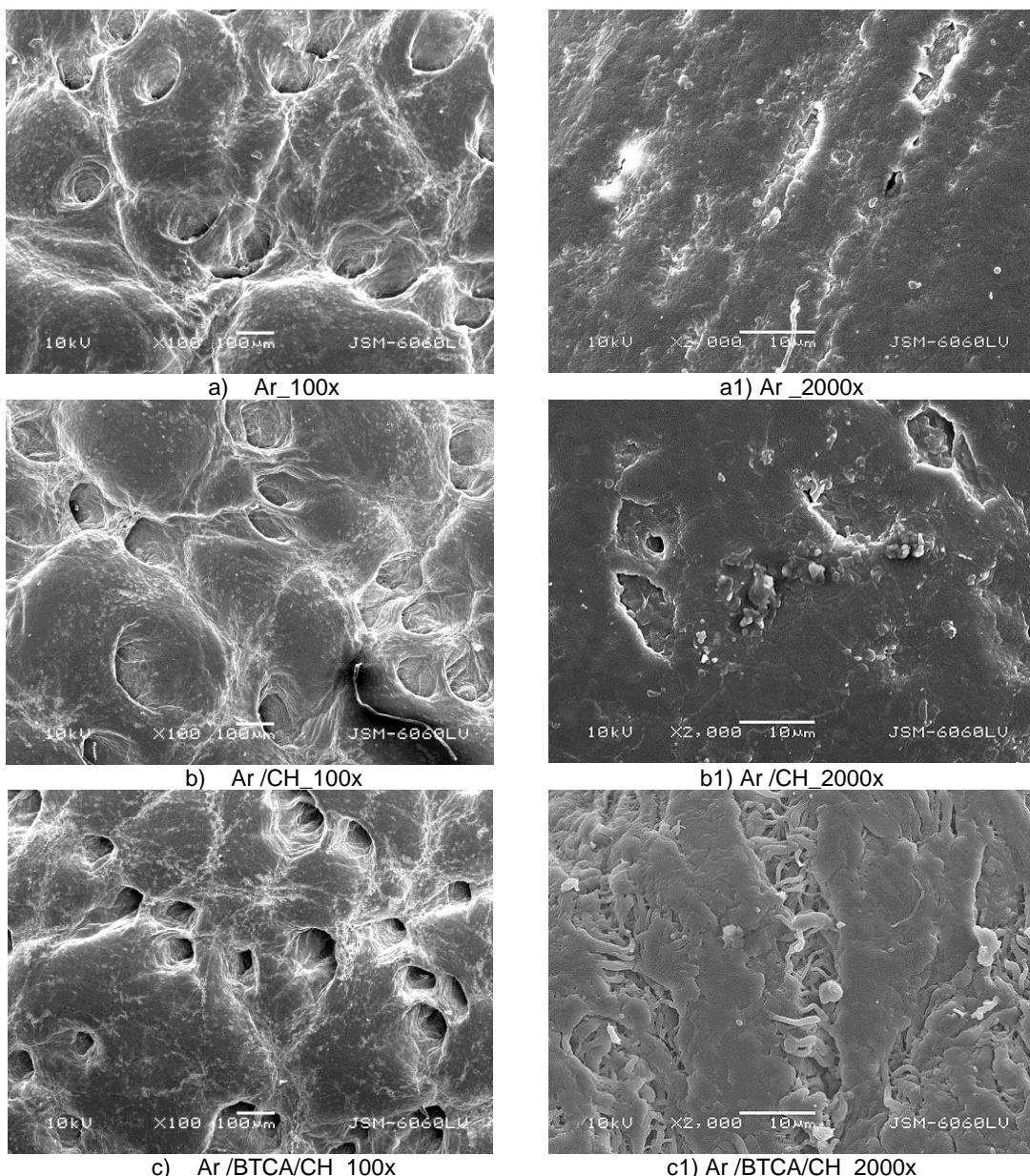
**Slika 53.** SEM snimke sintetski štavljenje kože uz povećanja 100x i 2000x: a) i a1) argonova plazma; b) i b1) obrada Ar/CH; c) i c1) obrada Ar/BTCA/CH
