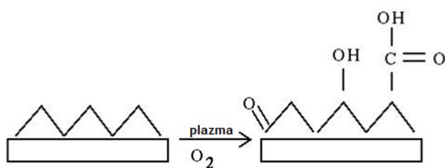
Slika 5. Aktivacija površine zamjenom vodika u polimernom lancu sa nekom drugom skupinom [17]
