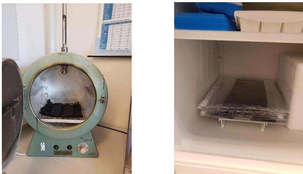
Slika 16: Prikaz pripreme uzoraka na 110 °C, -15 °C
