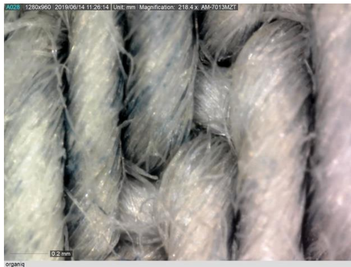
Slika 32. Uzorak obrađen OrganIQ BLEACH a) povećanje 55x; b) povećanje 230x
