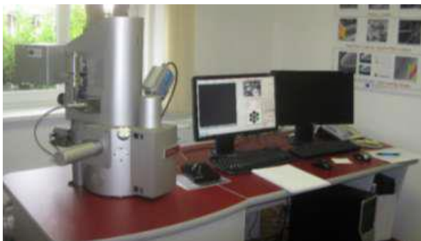
Slika 14. FE-SEM mikroskop Tescan, MIRA \LMU, na Zavodu za tekstilnu kemiju i ekologiju, TTF-a (uz dopuštenje Z. Kovačević)
