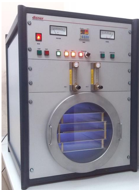
Slika 10. Plazma uređaj tip NANO LF-40kHz, Diener
