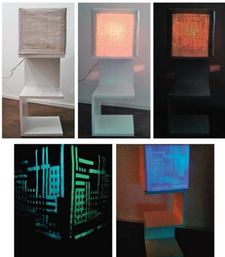
Sl.18 Sirovo platno tiskano transparentnom tiskarskom pastom uz dodatak fluorescentnog optičkog bjelila (2 strane) i fosforescentnog pigmenta (2 strane) pod različitim rasvjetom
