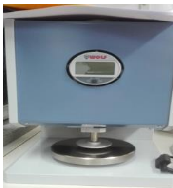
Slika 9. Uređaj za mjerenje debljine tkanina
