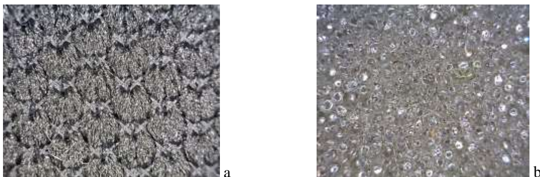
Slika 9: Izgled uzorka: a - prednja strana kompozita (uvećanje 200x); b - spužva - naličje kompozita
