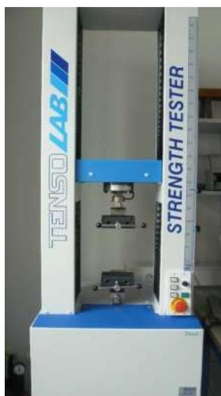
Slika 12. Kidalica Tensolab 3000, tt. Mesdan S.p.A., Italija
