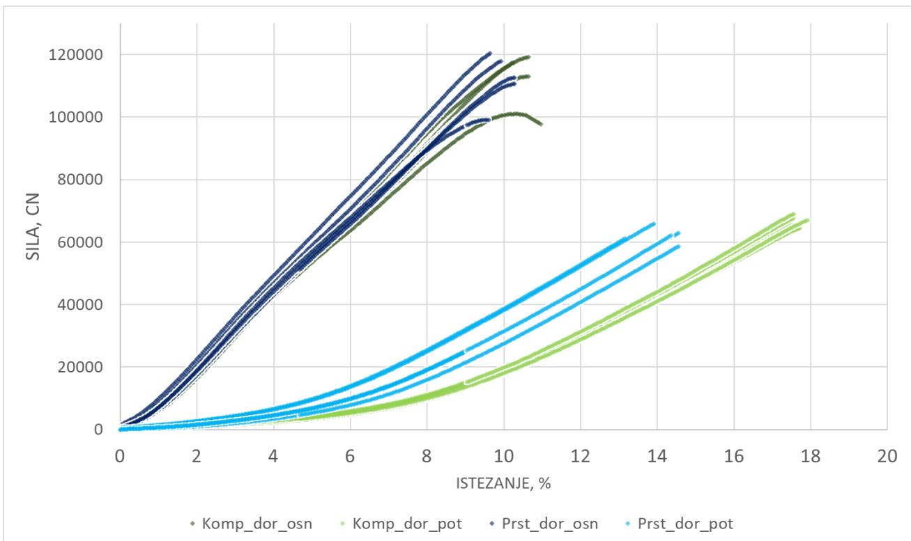
**Sl. 34.** Vlačne karakteristike dorađenih tkanina (usporedba uzoraka iz prstenaste i kompaktne pređe)
