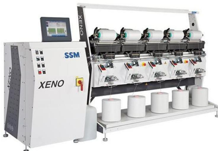
Sl. 5. Stroj za prematanje XENO – tt. SSM [14]
