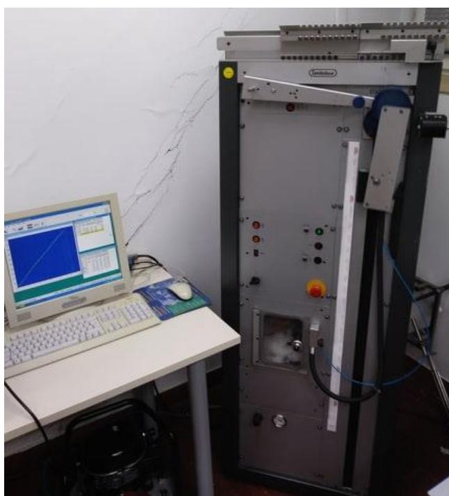
Sl. 22. Dinamometar Statimat M – tt. Textechno, Njemačka
