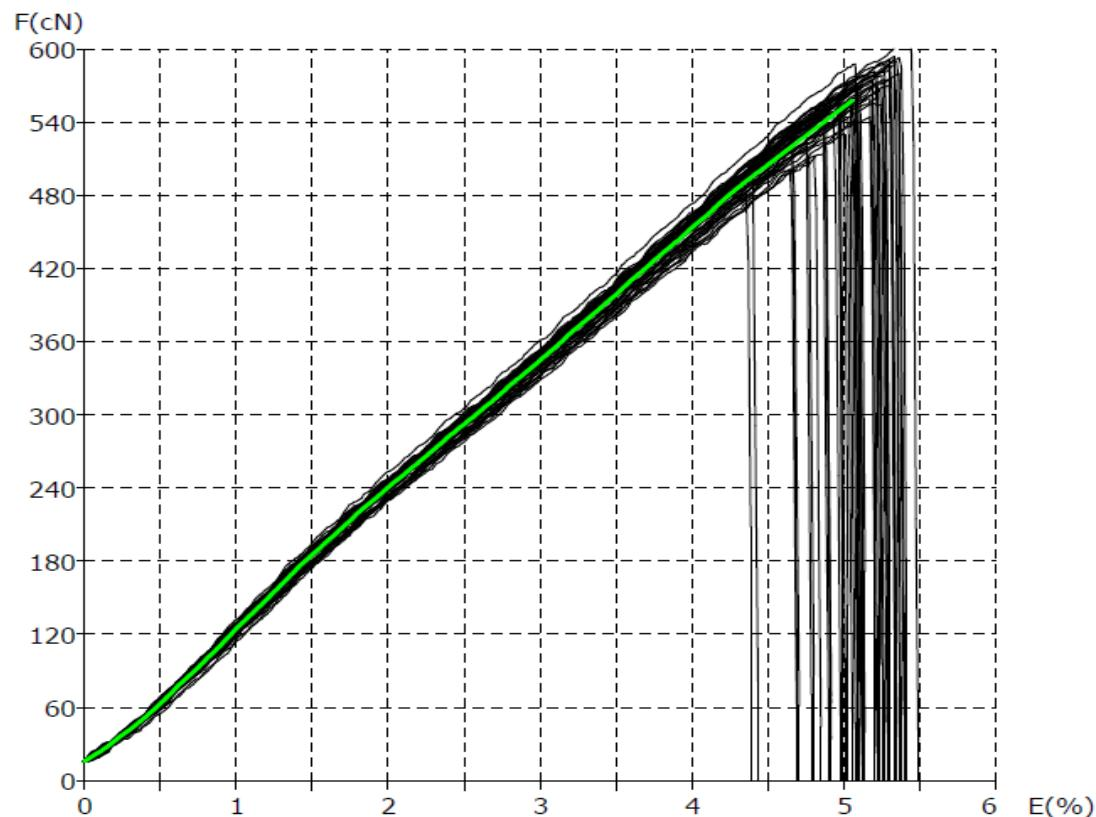
SI. 27. Vlačne karakteristike kompaktne pređe
