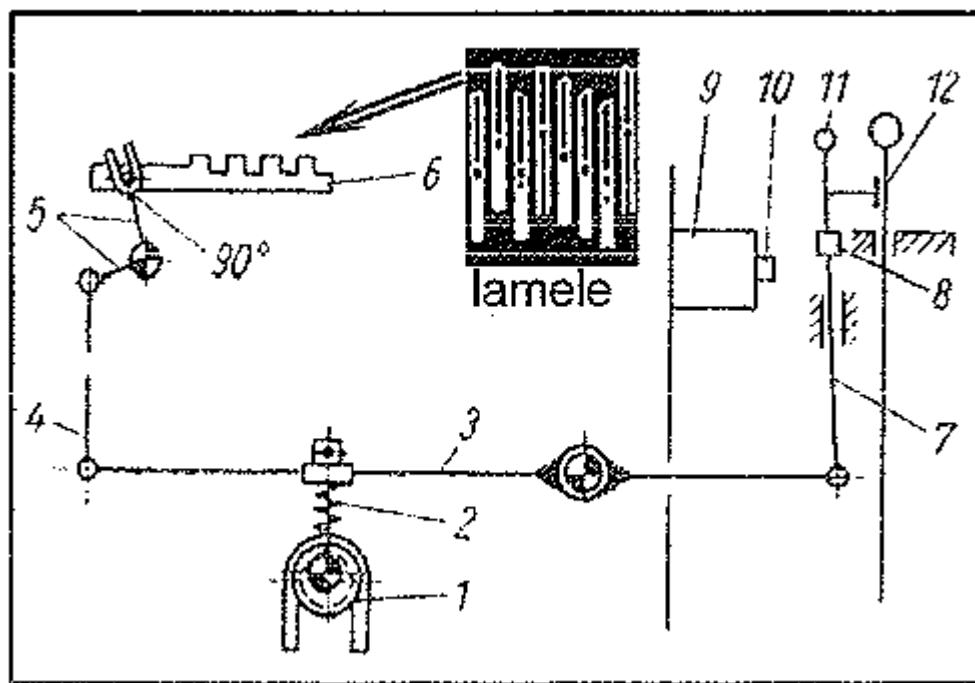
Sl. 15. Shema lamelnog mehaničkog čuvara osnovnih niti [16]
