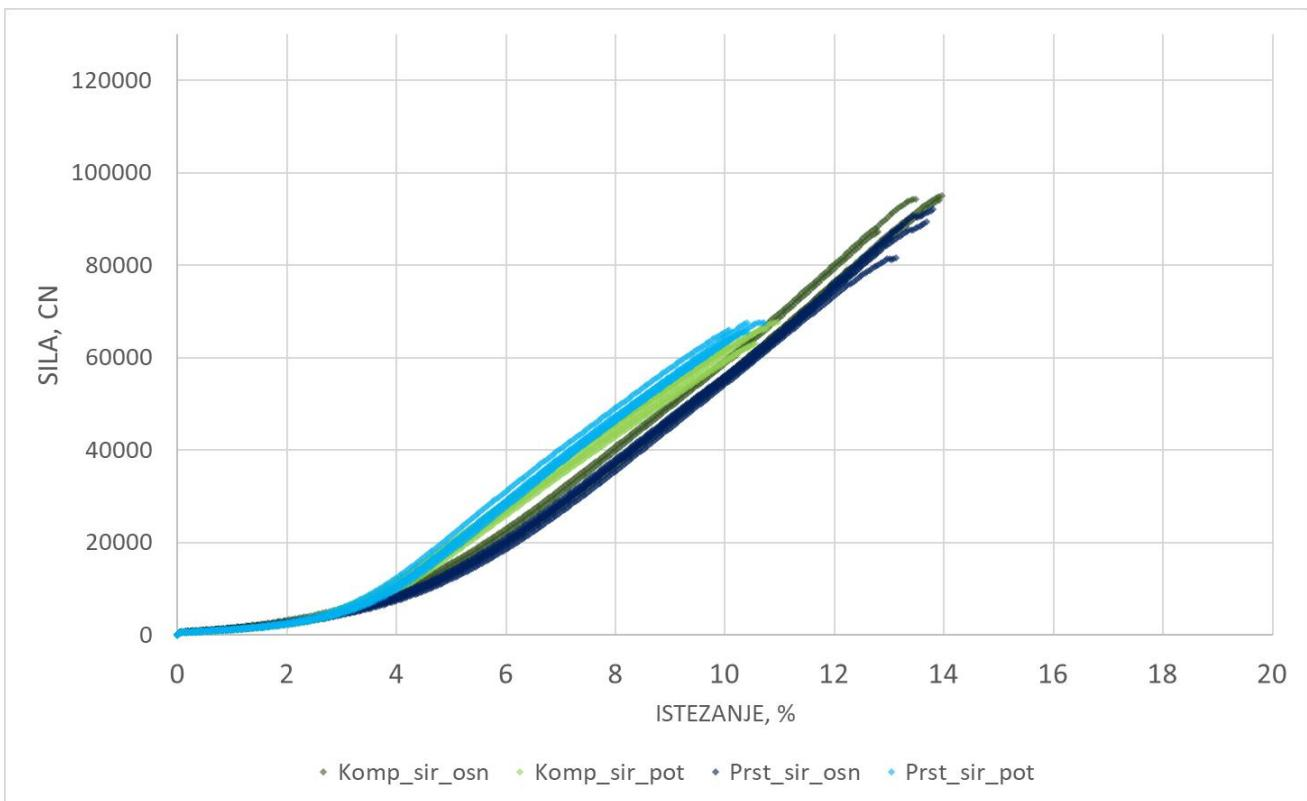
**Sl. 33.** Vlačne karakteristike sirovih tkanina (usporedba uzoraka iz prstenaste i kompaktne pređe)
