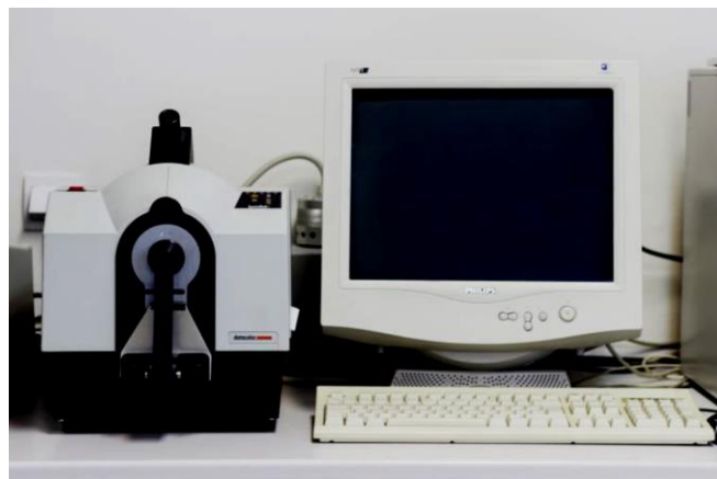
Slika 12. Remisijski spektrofotometar DataColor SP600+ CV UV []
