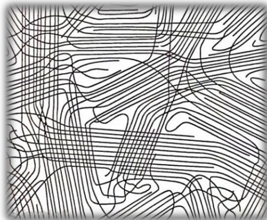
SI.5. Shematski prikaz rasporeda makromolekula u polietilenu [4]
