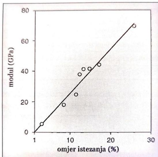
**SI.9.** Ovisnost modula elastičnosti o omjeru istezanja [5]
