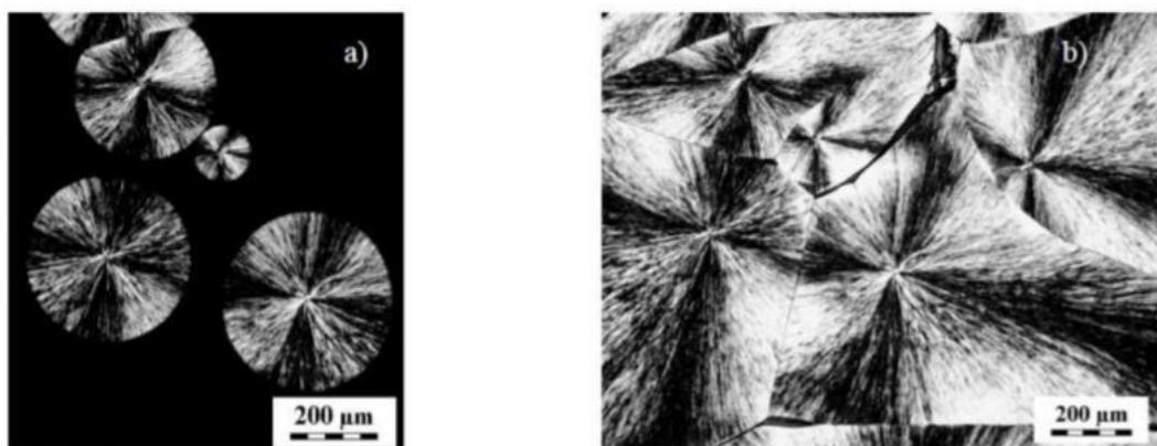
**SI.4.** Pojedinačni sferoliti (a) i sferoliti snimljeni polarizacijskim mikroskopom (b) u kristaliziranom poli(etilen-dioksidu). [3]
