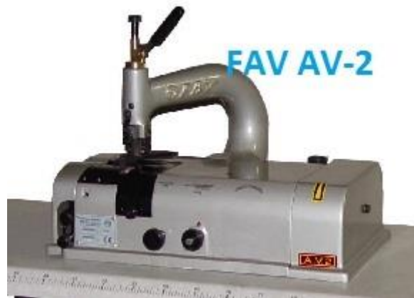
Slika.12. Stroj za tančanje kože [16]
