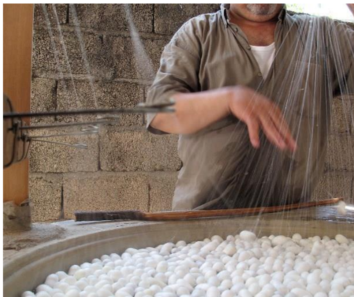
Sl. 25. Odmatanje svilenih niti s čahura [32]
