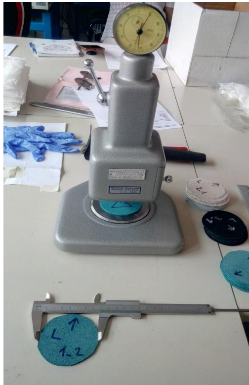
Slika 14. Mjerenje debljine i promjera
