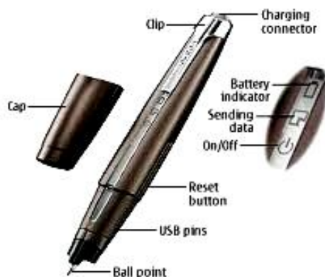
Sl. 17 Uređaj za digitalizaciju DigiPen
