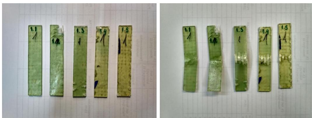
Slika 41. Epruvete kompozitne ploče S1\_IV. za ispitivanje savojne čvrstoće prije i poslije ispitivanja
