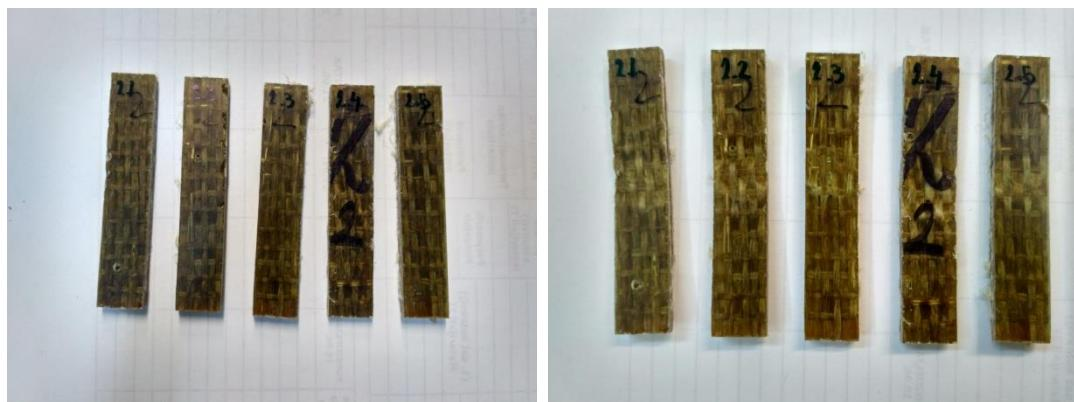
Slika 43. Epruvete kompozitne ploče L1\_I. za ispitivanje savojne čvrsoće prije i poslije ispitivanja
