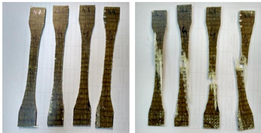
Slika 39. Epruvete kompozitne ploče S1L1\_II. za ispitivanje vlačne čvrstoće prije i poslije ispitivanja
