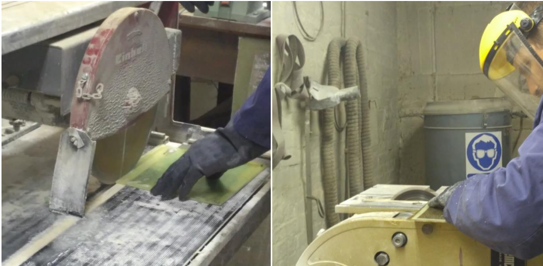
Slika 27. Rezanje ploča na mokrom i suhom rezaču
