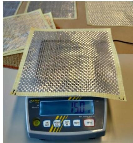
Slika 9. Određivanje mase uzorka
