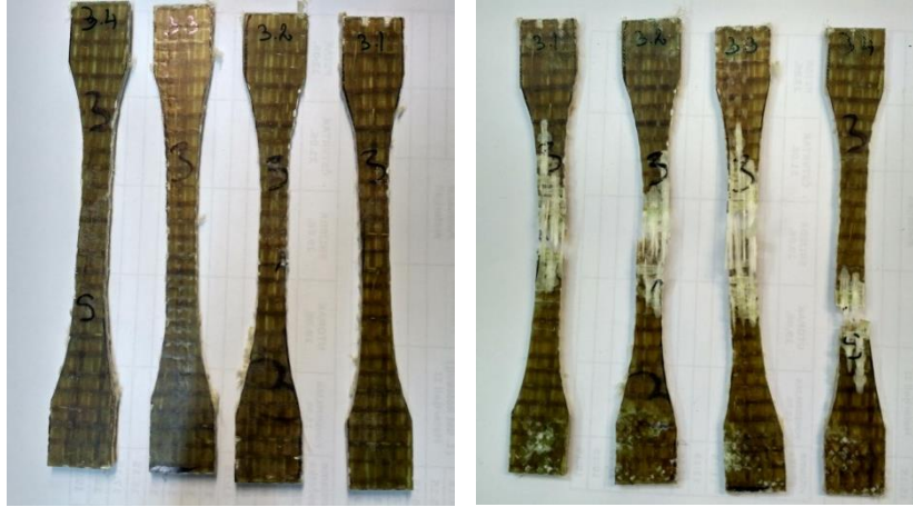
Slika 37. Epruvete kompozitne ploče S1L1_I. za ispitivanje vlačne čvrstoće prije i poslije ispitivanja
