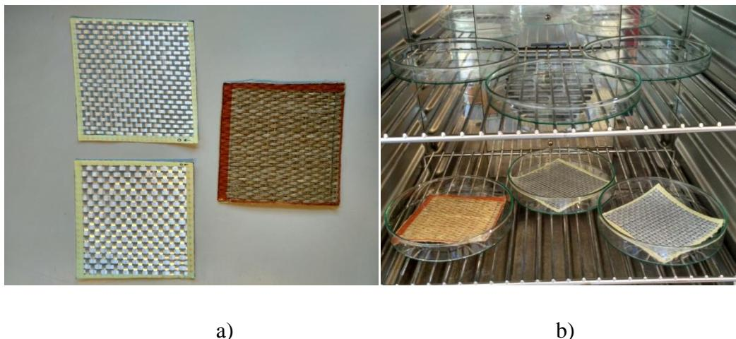
Slika 10. a) uzorci za ispitivanje dimenzija 10x10 cm, b) sušenje uzorka
