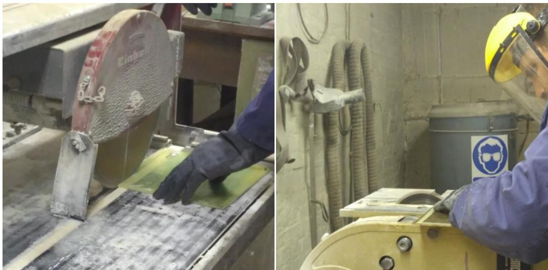
Slika 27. Rezanje ploča na mokrom i suhom rezaču
