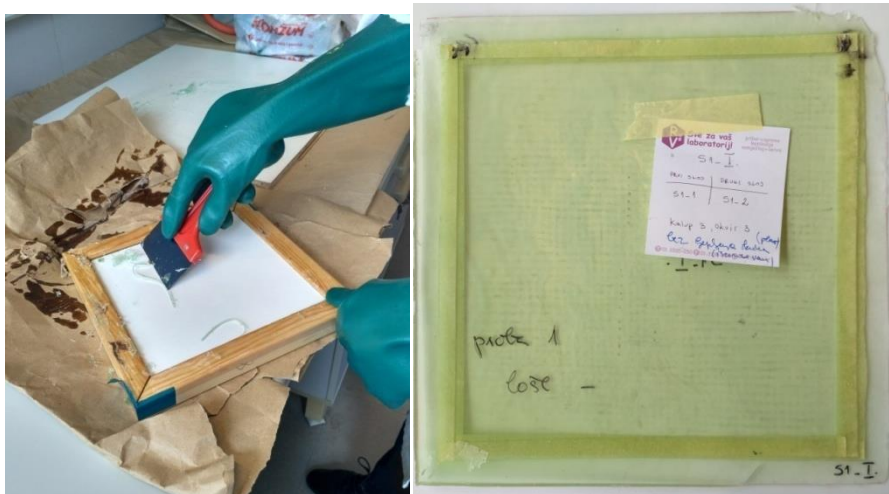
Slika 14. Odvajanje kalupa i rezultat izrade kompozitne ploče S1_I.
