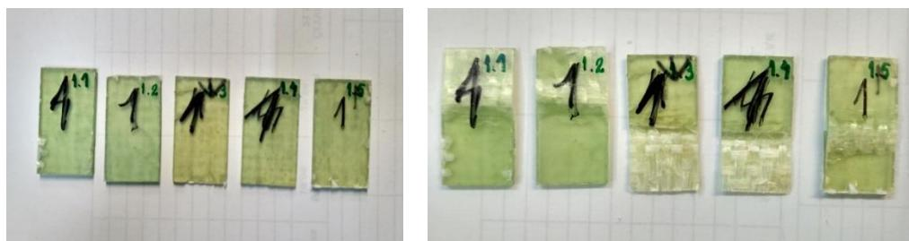
Slika 49. Epruvete kompozitne ploče S1\_IV. prije i poslije ispitivanja međuslojne tvrdoće
