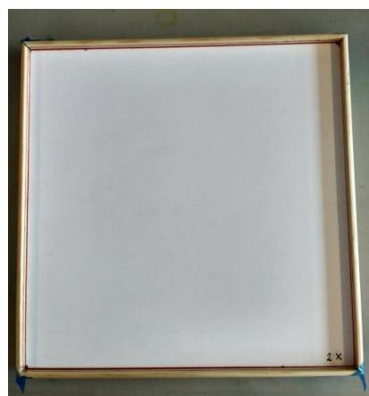
Slika 11. Kalup za izradu kompozitnih ploča- podloga i okvir
