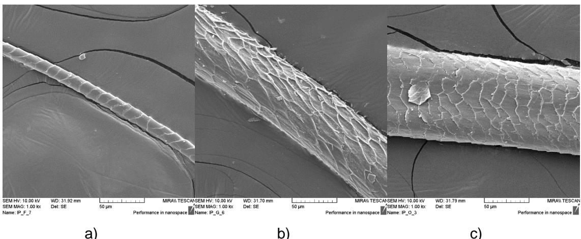
**Slika 17:** Površina vlakana vune ličke pramenke: a) fino vlakno, b) grubo vlakno, c) osjasto (kemp) vlakno
