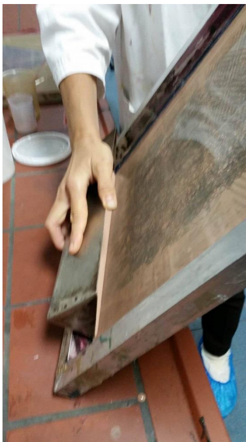
Slika 46: Nanošenje fotoemulzije na sito
