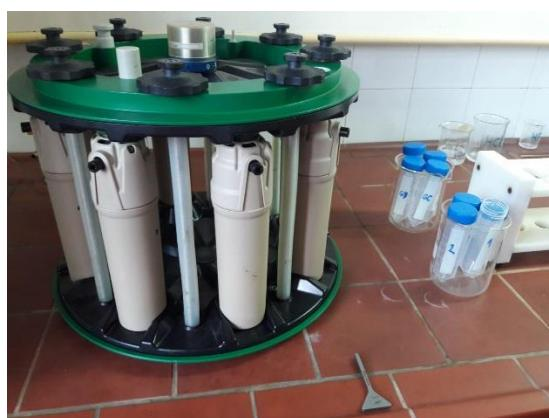
Sl. 19 Zatvorene kivete u keramičkim kućištima učvršćene u rotor, specijalni ključ za otvaranje ventila za odzračivanje (isključivo za otvaranje-nakon digestije)
