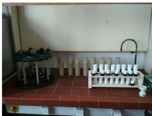
Sl. 18 Otvorene kivete i pravilno odloženi čepovi kiveta na odgovarajućem stalu, iza-keramička kućišta za kivete, lijevo- prazan rotor bez poklopca
