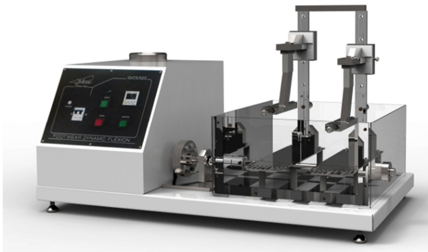
Slika 29. Prikaz uređaja za ispitivanje otpornosti na savijanje zaštitnih cipela [21]
