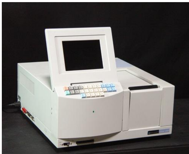
SI.3.3.5.1. UV/Vis spektrofotometar, Perkin Elmer Lambda EZ 201 [40].
