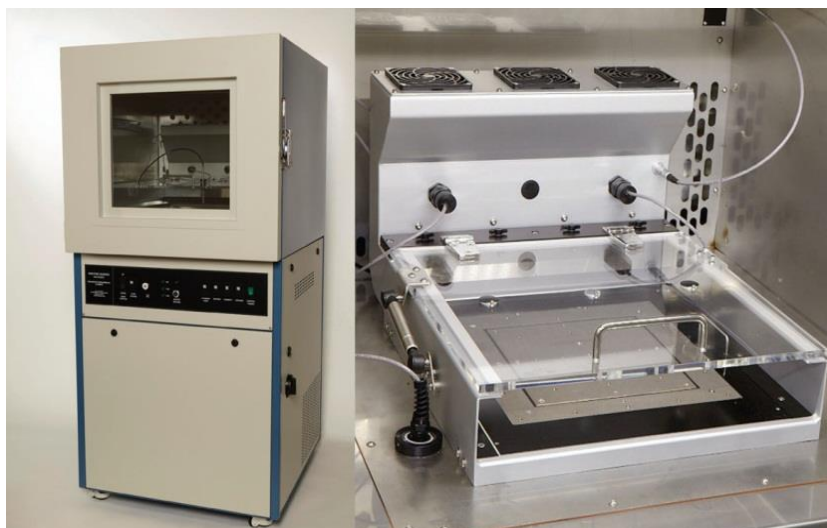
Slika 5. Vruća ploča eng. Sweating Guarded Hot Plate - skin model
