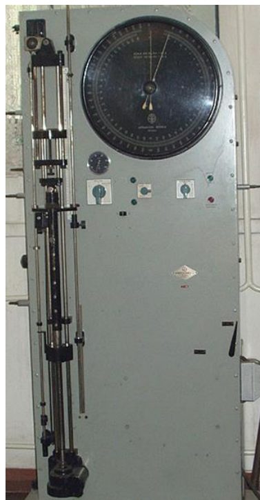
Slika 4. Dinamometar Aparecchi Branca S.A., Italija za određivanje otpornosti plošnih proizvoda prema prskanju
