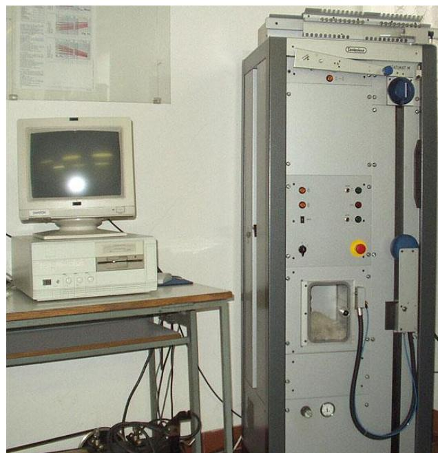
Sl. 12. Dinamometar Statimat M za mjerjenje vlačnih svojstava pređe
