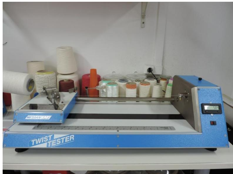
Sl. 11. Torziometar Twist Tester za određivanje uvojitošći pređe
