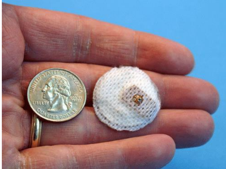
Sl.20. Digitalna komponenta za mjerenje temperature veličine novčića
