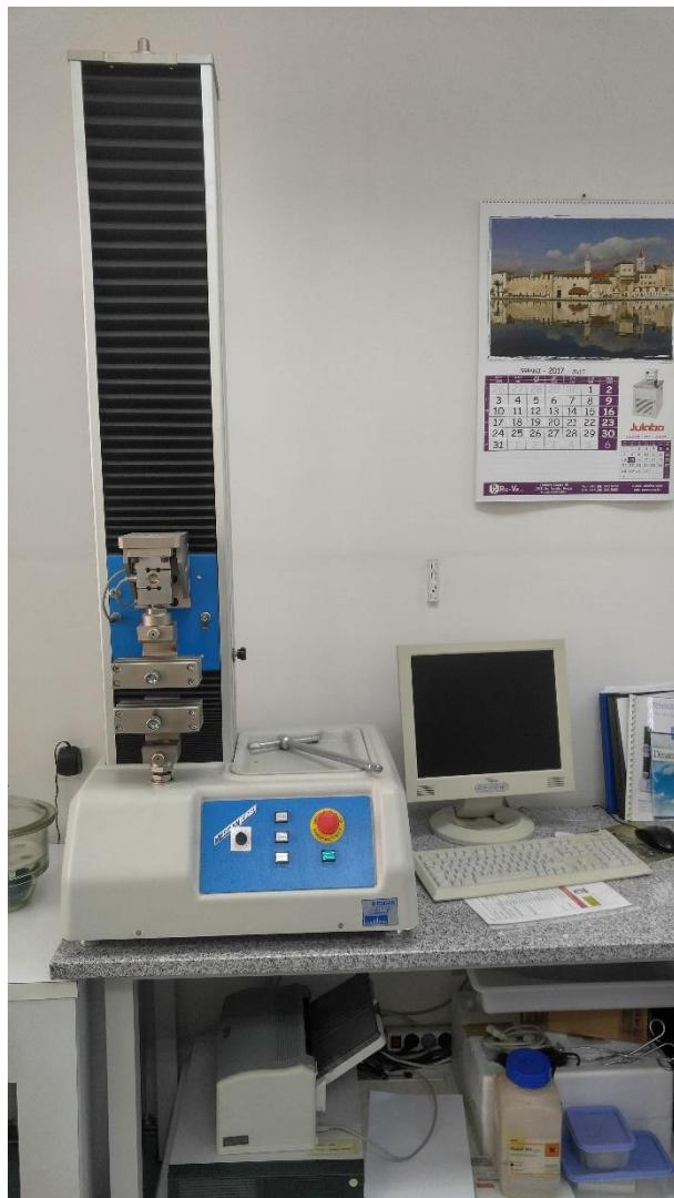
**Slika 8.** Dinamometar Tensolab, MESDAN-LAB
