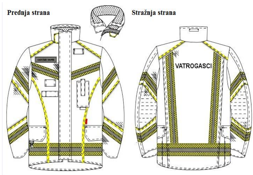
Slika 24. Tehnički crtež jakne vatrogasnog odijela
