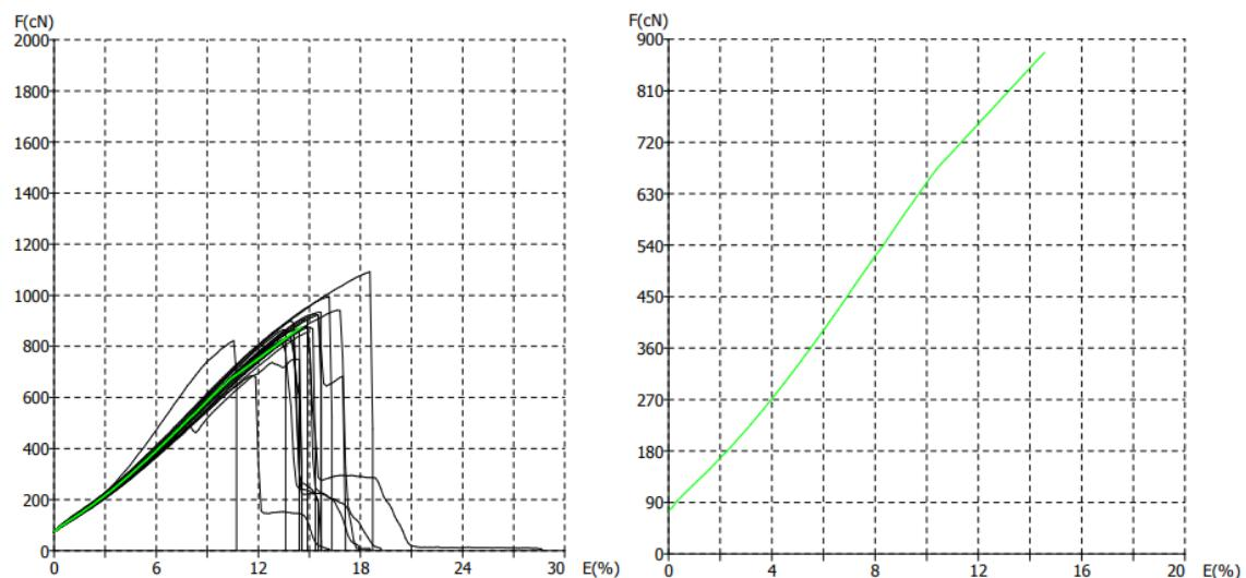
Slika 38. Prikaz F/E dijagrama pojedinačnih mjerena (lijevo) i dijagram prosječne vrijednosti (desno) konfiguracije U11 – ispitivanje u mokrom stanju
