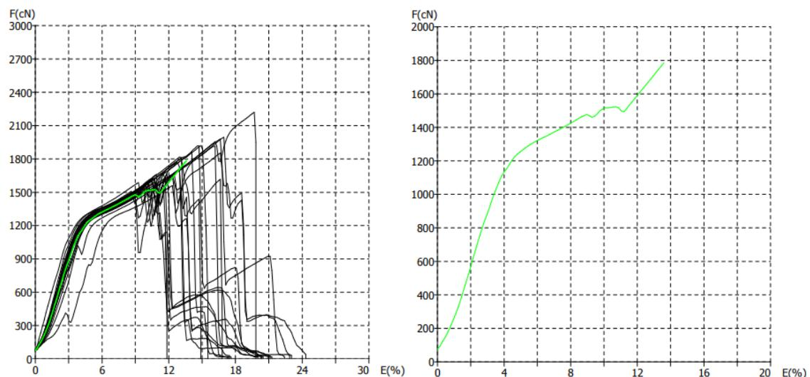
Slika 23. Prikaz F/E dijagrama pojedinačnih mjerena (lijevo) i dijagram prosječne vrijednosti (desno) konfiguracije U8 – ispitivanje u suhom stanju
