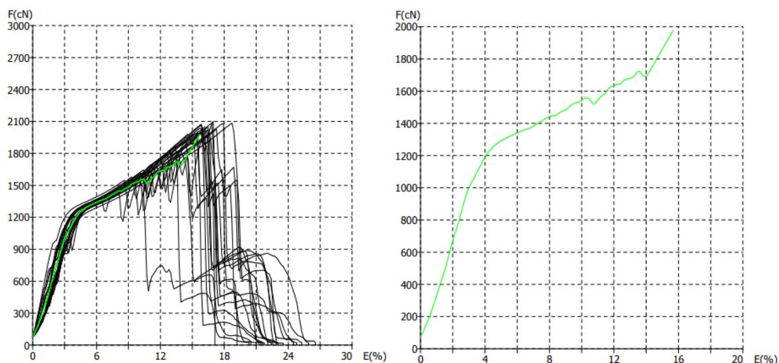
Slika 20. Prikaz F/E dijagrama pojedinačnih mjerena (lijevo) i dijagram prosječne vrijednosti (desno) konfiguracije U5 – ispitivanje u suhom stanju
