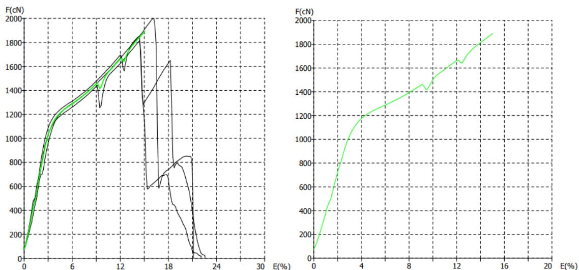
Slika 44. Prikaz F/E dijagrama pojedinačnih mjerena (lijevo) i dijagram prosječne vrijednosti (desno) konfiguracije U5 – ispitivanje nakon procesa habanja
