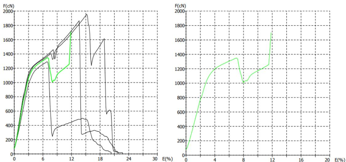
Slika 42. Prikaz F/E dijagrama pojedinačnih mjerena (lijevo) i dijagram prosječne vrijednosti (desno) konfiguracije U3 – ispitivanje nakon procesa habanja
