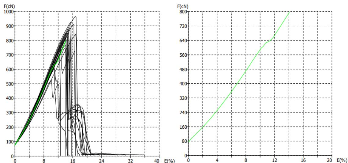
Slika 37. Prikaz F/E dijagrama pojedinačnih mjerjenja (lijevo) i dijagram prosječne vrijednosti (desno) konfiguracije U10 – ispitivanje u mokrom stanju
