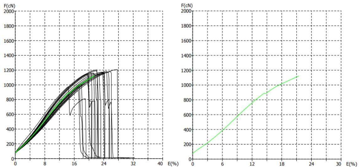
Slika 29. Prikaz F/E dijagrama pojedinačnih mjerena (lijevo) i dijagram prosječne vrijednosti (desno) konfiguracije U2 – ispitivanje u mokrom stanju
