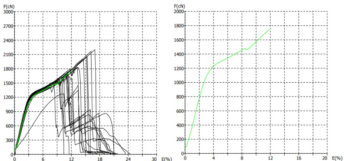
Slika 26. Prikaz F/E dijagrama pojedinačnih mjerena (lijevo) i dijagram prosječne vrijednosti (desno) konfiguracije U11 – ispitivanje u suhom stanju
