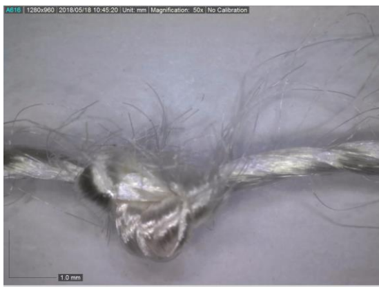
Slika 57. Fotografija konfiguracije U6 nakon procesa habanja
