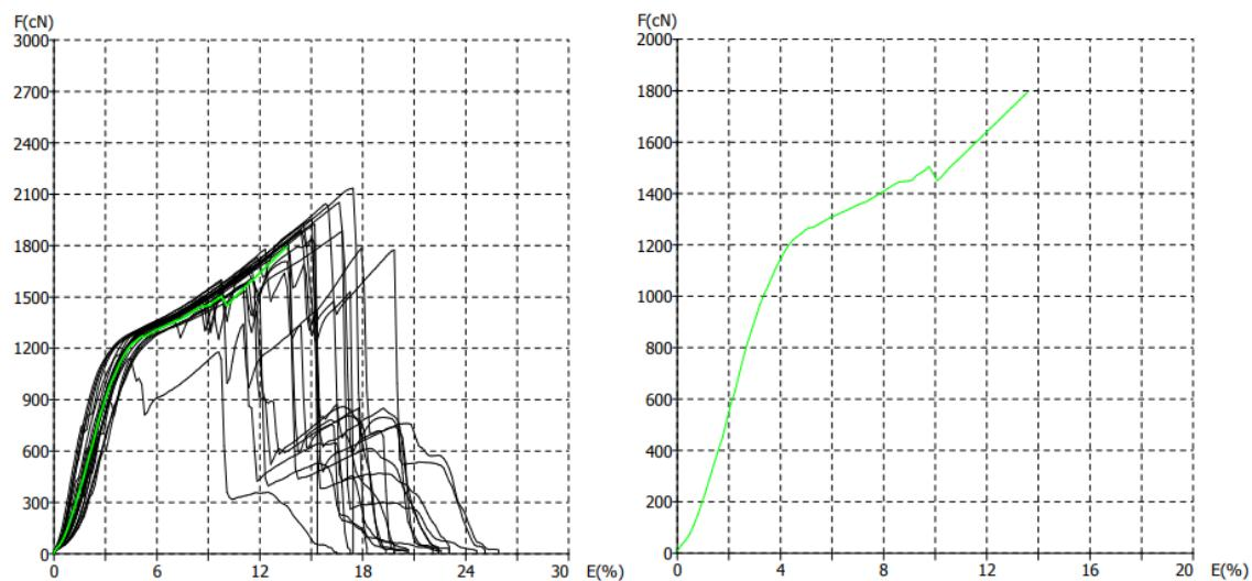
Slika 19. Prikaz F/E dijagrama pojedinačnih mjerena (lijevo) i dijagram prosječne vrijednosti (desno) konfiguracije U4 – ispitivanje u suhom stanju
