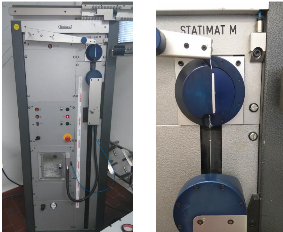
Slika 2. Prikaz dinamometra tt. Textechno (lijevo) i prikaz stezaljki dinamometra prilikom ispitivanja (desno)
