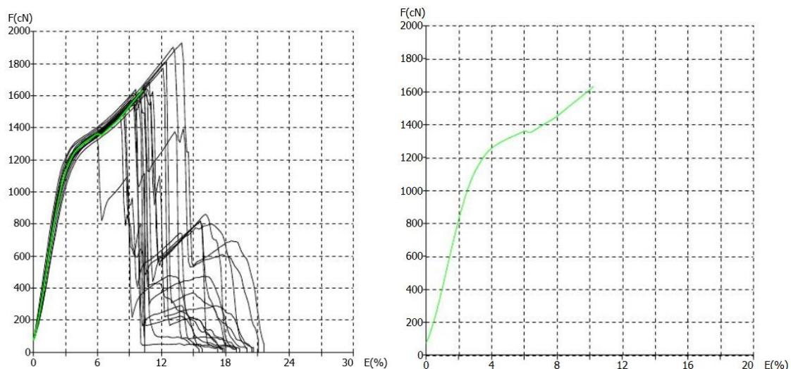
Slika 16. Prikaz F/E dijagrama pojedinačnih mjeranja (lijevo) i dijagram prosječne vrijednosti (desno) konfiguracije U1 – ispitivanje u suhom stanju
