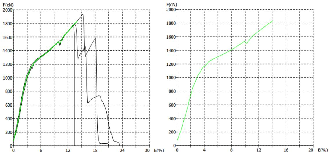
Slika 51 . Prikaz F/E dijagrama pojedinačnih mjerena (lijevo) i dijagram prosječne vrijednosti (desno) konfiguracije U12 – ispitivanje nakon procesa habanja
