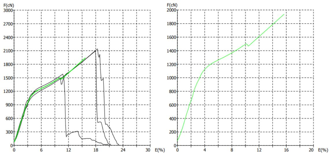
Slika 45. Prikaz F/E dijagrama pojedinačnih mjerena (lijevo) i dijagram prosječne vrijednosti (desno) konfiguracije U6 – ispitivanje nakon procesa habanja
