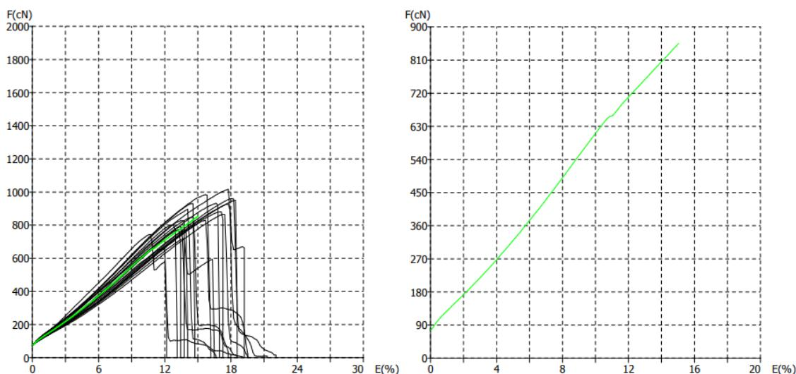
Slika 28. Prikaz F/E dijagrama pojedinačnih mjerena (lijevo) i dijagram prosječne vrijednosti (desno) konfiguracije U1 – ispitivanje u mokrom stanju
