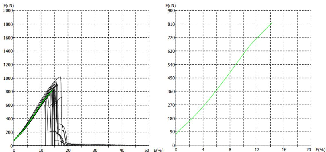
Slika 34. Prikaz F/E dijagrama pojedinačnih mjerena (lijevo) i dijagram prosječne vrijednosti (desno) konfiguracije U7 – ispitivanje u mokrom stanju
