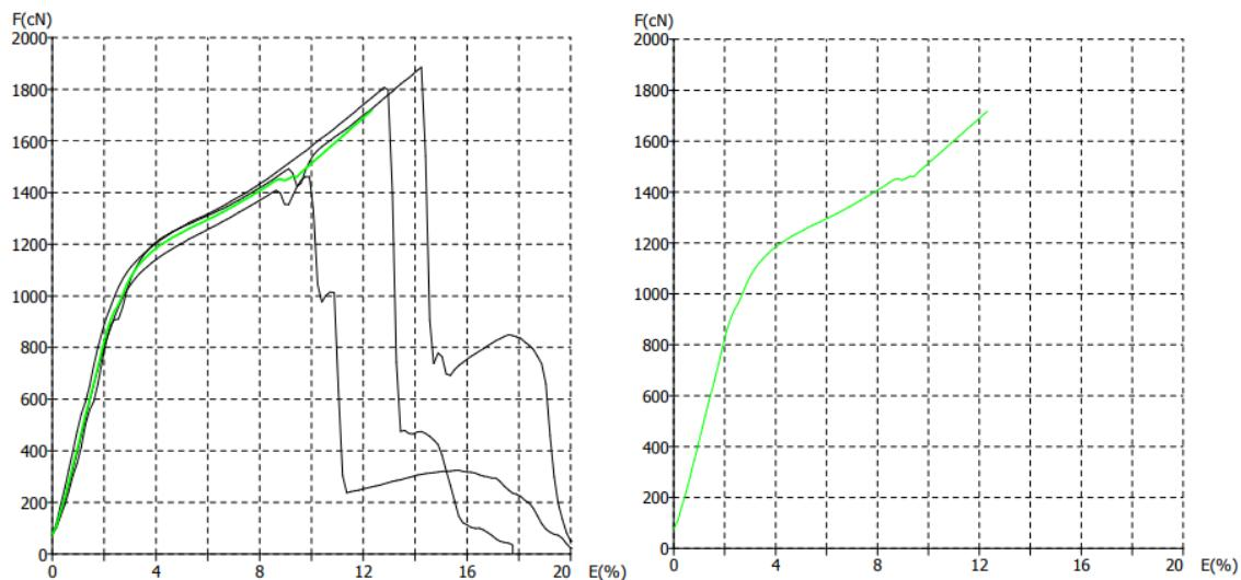
Slika 43. Prikaz F/E dijagrama pojedinačnih mjerena (lijevo) i dijagram prosječne vrijednosti (desno) konfiguracije U4 – ispitivanje nakon procesa habanja
