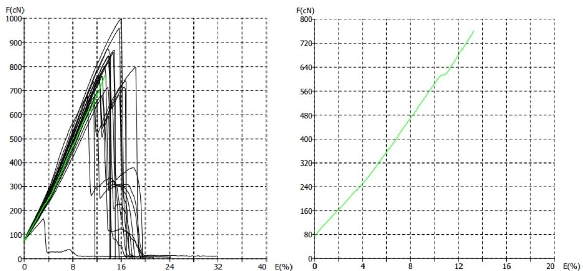
Slika 31. Prikaz F/E dijagrama pojedinačnih mjerena (lijevo) i dijagram prosječne vrijednosti (desno) konfiguracije U4 – ispitivanje u mokrom stanju
