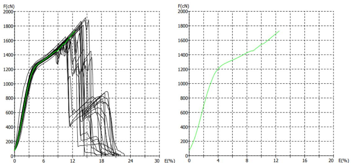
Slika 18. Prikaz F/E dijagrama pojedinačnih mjerena (lijevo) i dijagram prosječne vrijednosti (desno) konfiguracije U3 – ispitivanje u suhom stanju
