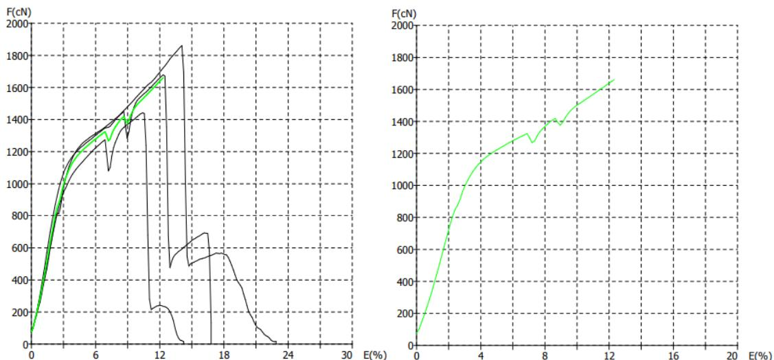
Slika 48. Prikaz F/E dijagrama pojedinačnih mjerena (lijevo) i dijagram prosječne vrijednosti (desno) konfiguracije U9 – ispitivanje nakon procesa habanja
