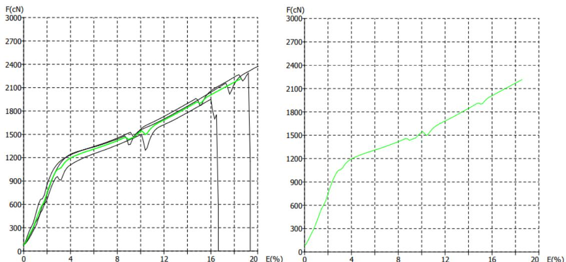
Slika 41. Prikaz F/E dijagrama pojedinačnih mjerjenja (lijevo) i dijagram prosječne vrijednosti (desno) konfiguracije U2 – ispitivanje nakon procesa habanja
