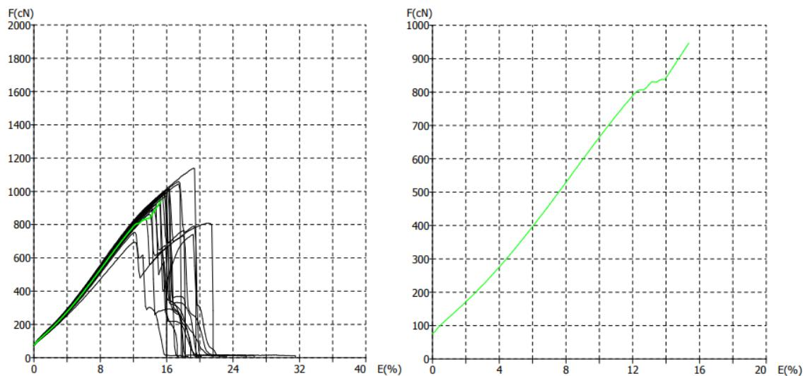
Slika 32. Prikaz F/E dijagrama pojedinačnih mjerena (lijevo) i dijagram prosječne vrijednosti (desno konfiguracije U5 – ispitivanje u mokrom stanju)
