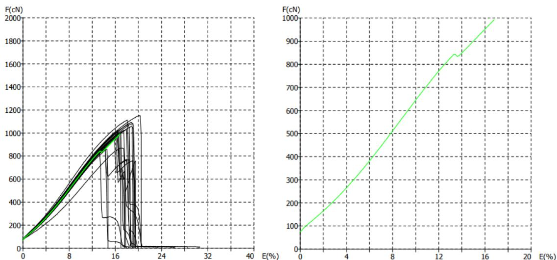
Slika 33. Prikaz F/E dijagrama pojedinačnih mjerjenja (lijevo) i dijagram prosječne vrijednosti (desno) konfiguracije U6 – ispitivanje u mokrom stanju
