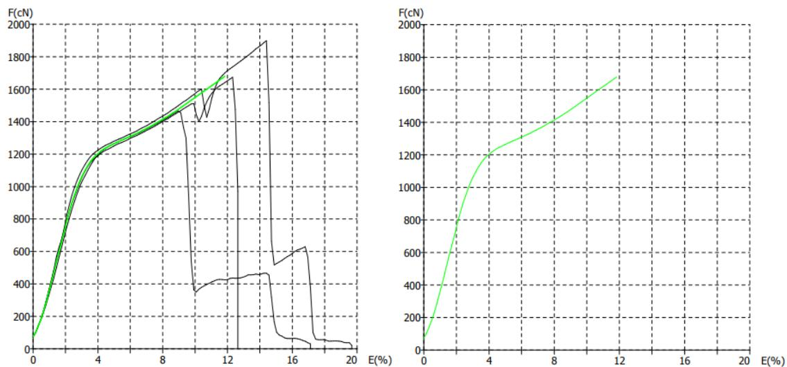
Slika 46. Prikaz F/E dijagrama pojedinačnih mjerjenja (lijevo) i dijagram prosječne vrijednosti (desno) konfiguracije U7 – ispitivanje nakon procesa habanja
