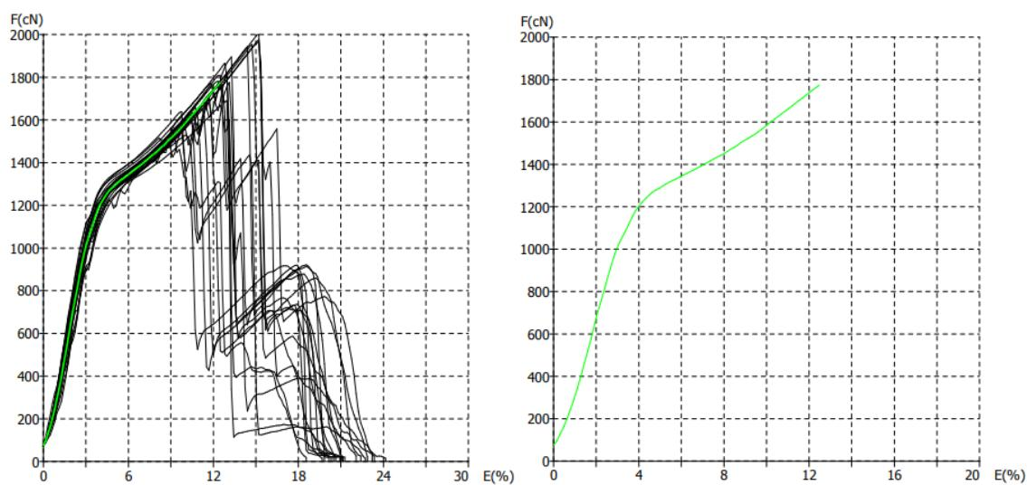
Slika 27. Prikaz F/E dijagrama pojedinačnih mjerena (lijevo) i dijagram prosječne vrijednosti (desno) konfiguracije U12 – ispitivanje u suhom stanju
