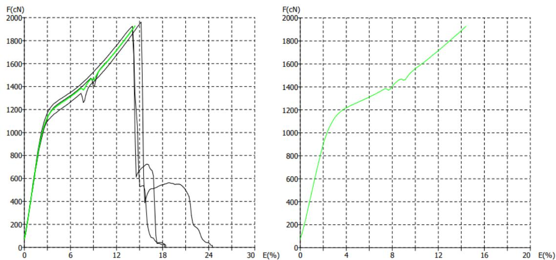
Slika 50. Prikaz F/E dijagrama pojedinačnih mjerena (lijevo) i dijagram prosječne vrijednosti (desno) konfiguracije U11 – ispitivanje nakon procesa habanja
