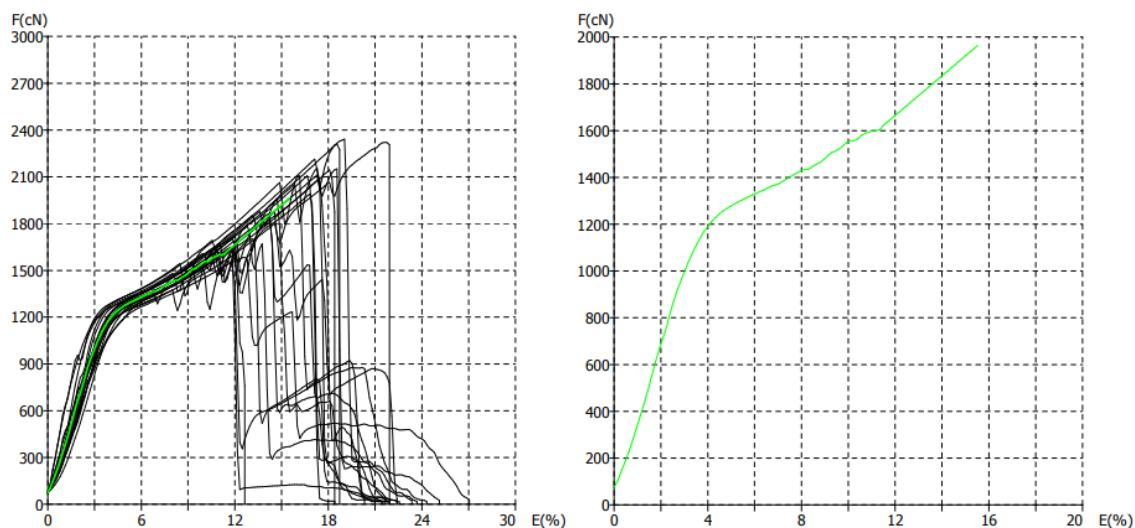
Slika 17. Prikaz F/E dijagrama pojedinačnih mjerena (lijevo) i dijagram prosječne vrijednosti (desno) konfiguracije U2 – ispitivanje u suhom stanju
