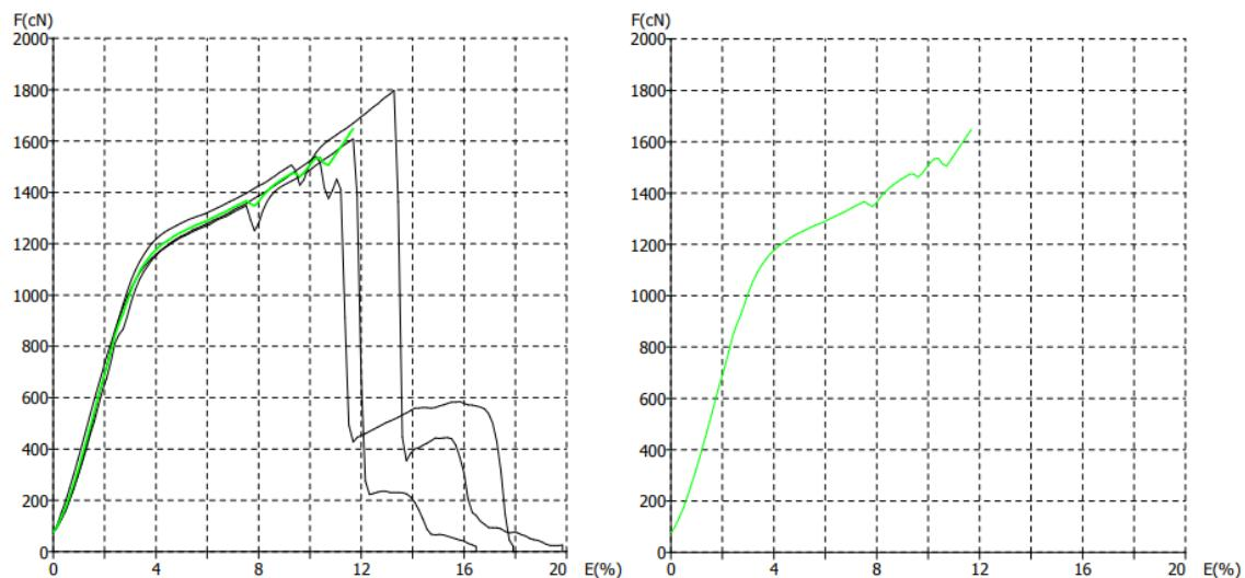
Slika 47. Prikaz F/E dijagrama pojedinačnih mjerena (lijevo) i dijagram prosječne vrijednosti (desno) konfiguracije U8 – ispitivanje nakon procesa habanja
