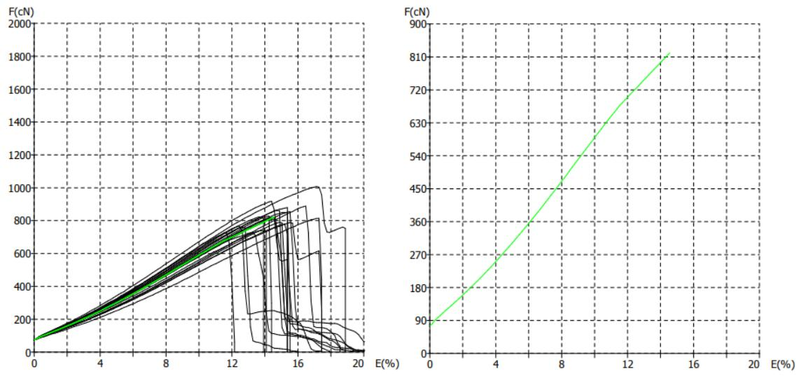
Slika 30 . Prikaz F/E dijagrama pojedinačnih mjerena (lijevo) i dijagram prosječne vrijednosti (desno) konfiguracije U3 – ispitivanje u mokrom stanju
