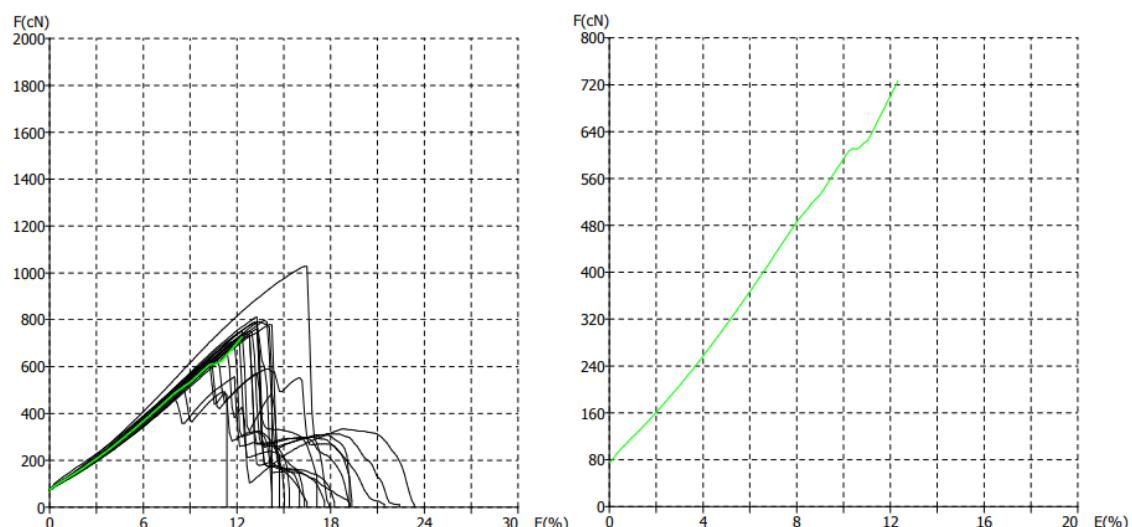
Slika 39. Prikaz F/E dijagrama pojedinačnih mjerena (lijevo) i dijagram prosječne vrijednosti (desno) konfiguracije U12 – ispitivanje u mokrom stanju
