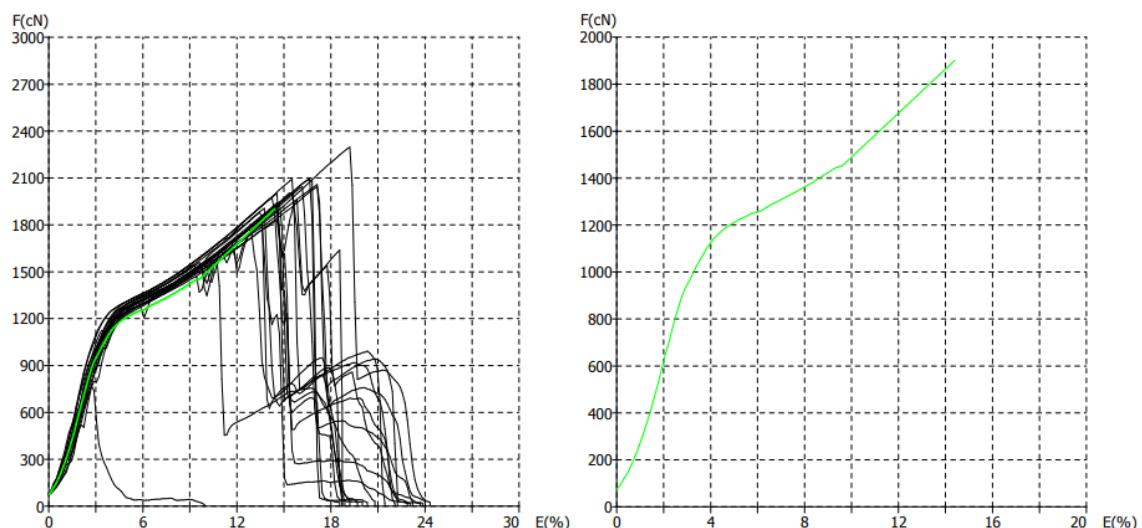
Slika 25. Prikaz F/E dijagrama pojedinačnih mjerena (lijevo) i dijagram prosječne vrijednosti (desno) konfiguracije U10 – ispitivanje u suhom stanju
