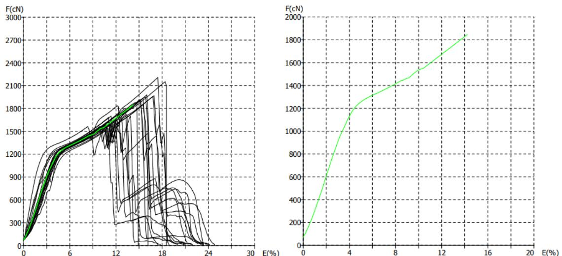
Slika 21. Prikaz F/E dijagrama pojedinačnih mjerjenja (lijevo) i dijagram prosječne vrijednosti (desno) konfiguracije U6 – ispitivanje u suhom stanju
