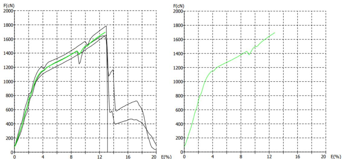
Slika 49. Prikaz F/E dijagrama pojedinačnih mjerjenja (lijevo) i dijagram prosječne vrijednosti (desno) konfiguracije U10 – ispitivanje nakon procesa habanja
