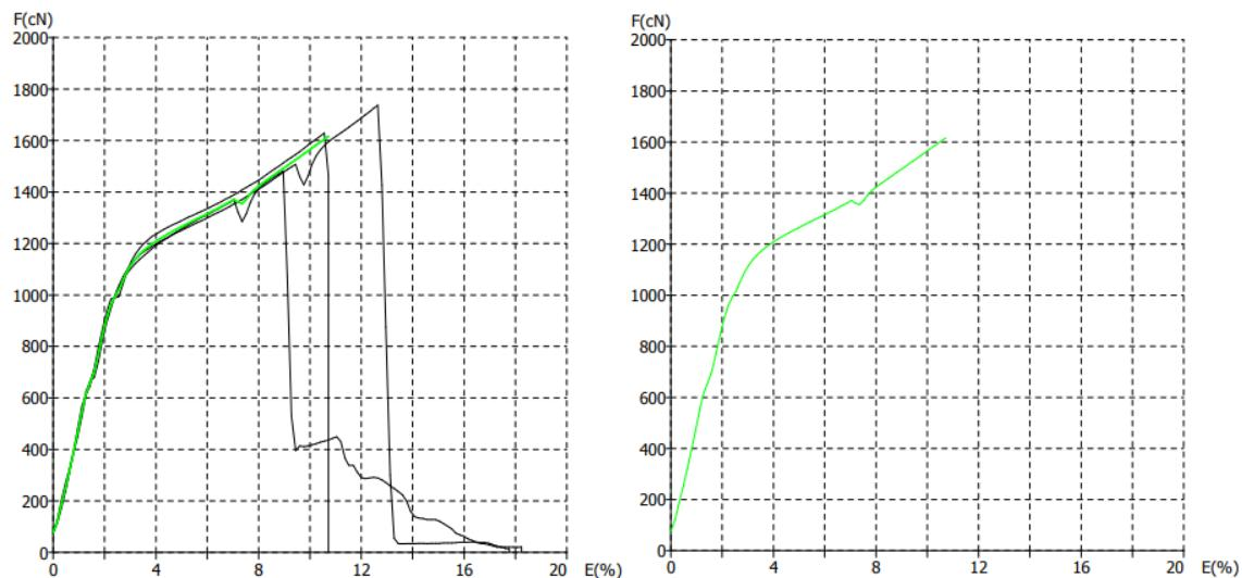
Slika 40. Prikaz F/E dijagrama pojedinačnih mjerena (lijevo) i dijagram prosječne vrijednosti (desno) konfiguracije U1 – ispitivanje nakon procesa habanja
