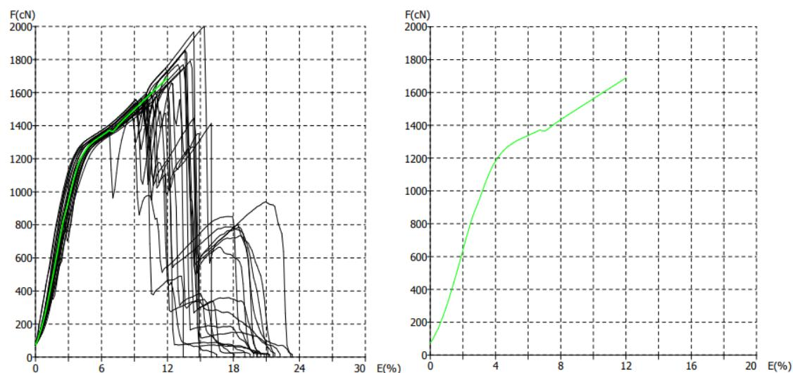
Slika 22. Prikaz F/E dijagrama pojedinačnih mjerena (lijevo) i dijagram prosječne vrijednosti (desno) konfiguracije U7 – ispitivanje u suhom stanju
