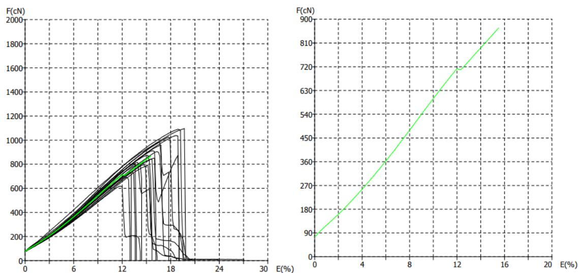
Slika 36. Prikaz F/E dijagrama pojedinačnih mjerena (lijevo) i dijagram prosječne vrijednosti (desno) konfiguracije U9 – ispitivanje u mokrom stanju
