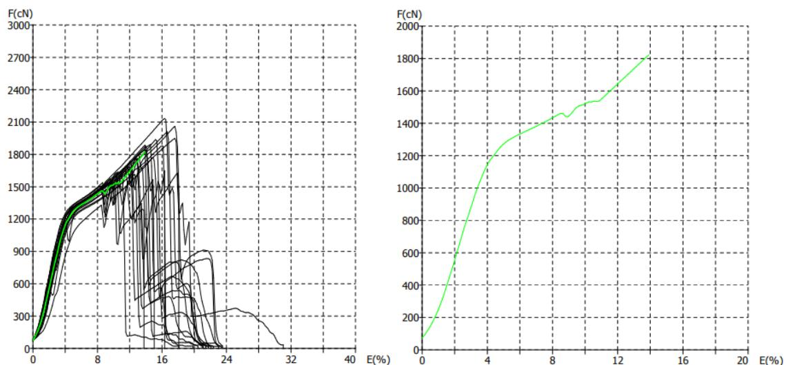
Slika 24 . Prikaz F/E dijagrama pojedinačnih mjerena (lijevo) i dijagram prosječne vrijednosti (desno) konfiguracije U9 – ispitivanje u suhom stanju
