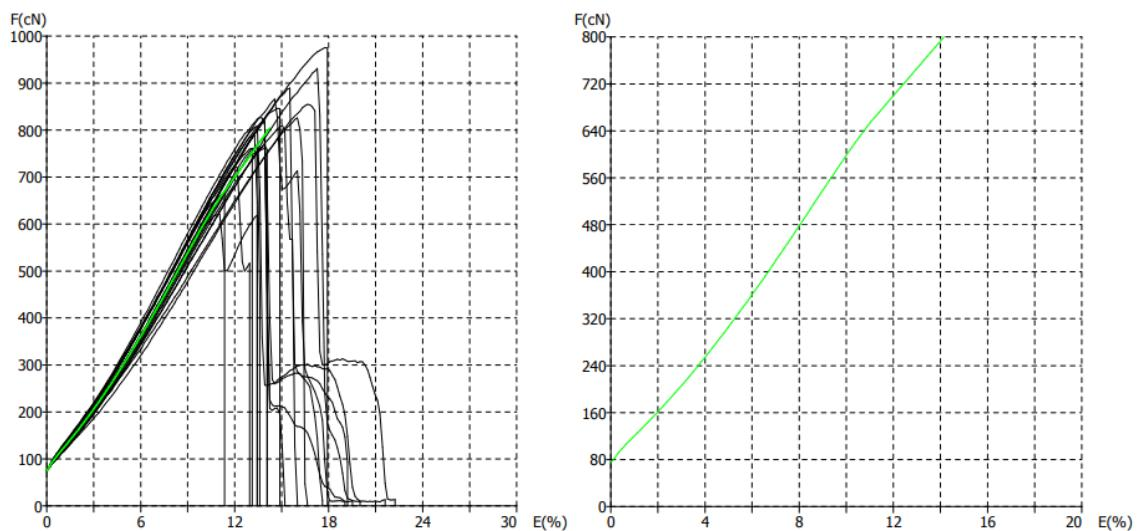
Slika 35. Prikaz F/E dijagrama pojedinačnih mjerena (lijevo) i dijagram prosječne vrijednosti (desno) konfiguracije U8 – ispitivanje u mokrom stanju
