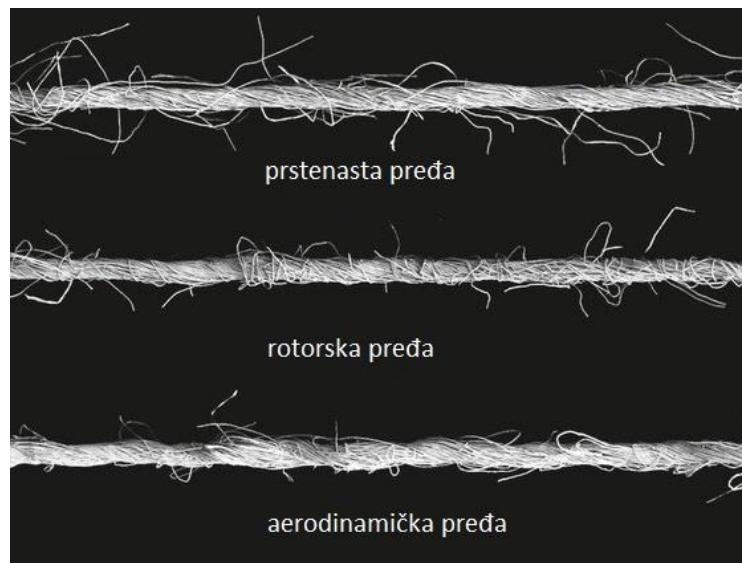
Slika 11. Usporedba izgleda pređa proizvedenih prstenastim, rotorskim i aerodinamičkim predenjem [13]
