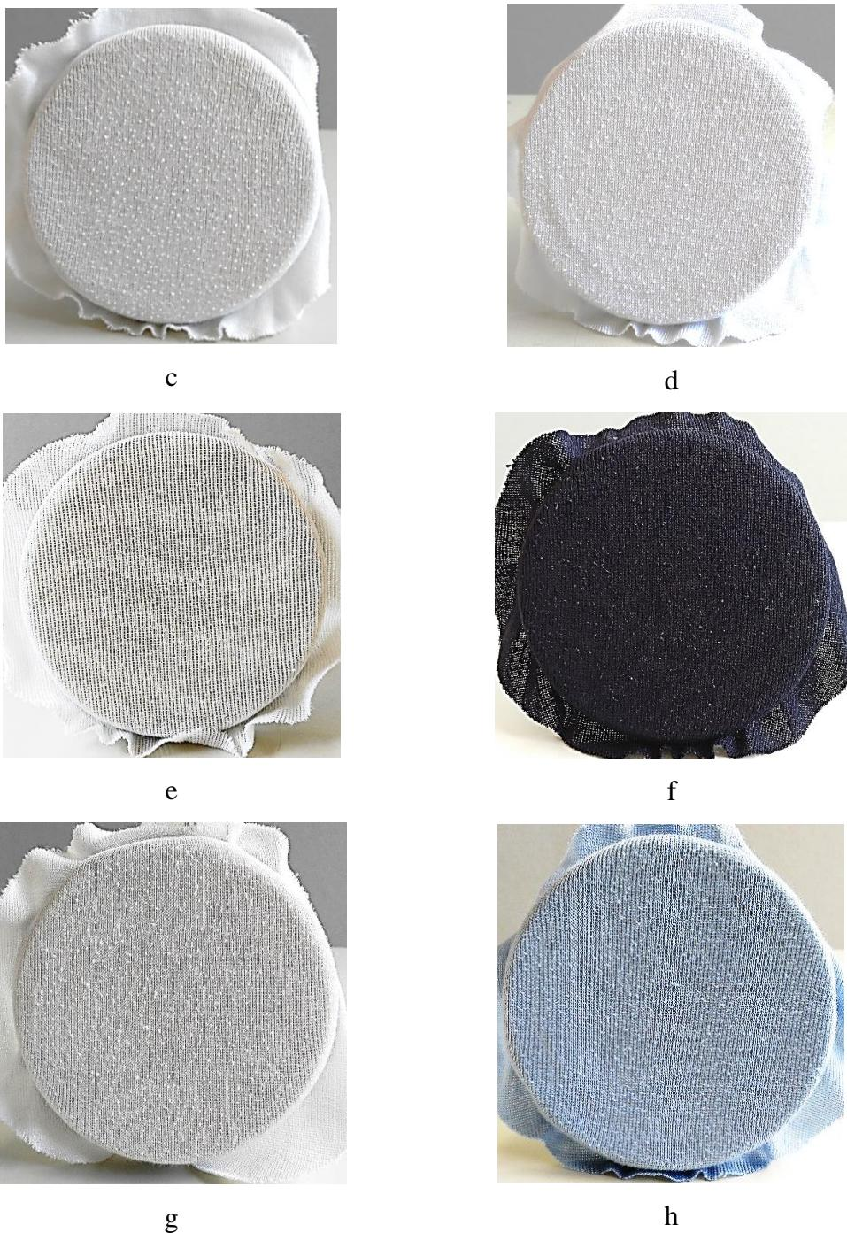
Slika 30. Uzorci pletiva po ispitivanju sklonosti nastanka površinskog pilinga nakon 7 000 habajućih ciklusa:
