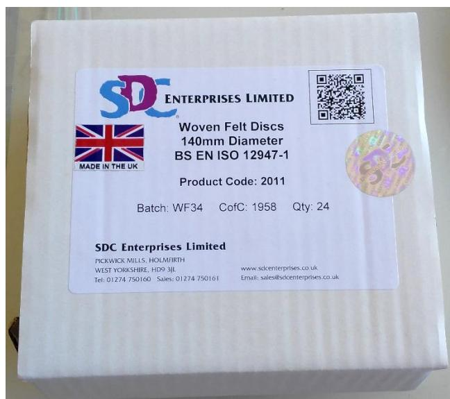
Slika 18. Filc primijenjen kod ispitivanja otpornosti na habanje
