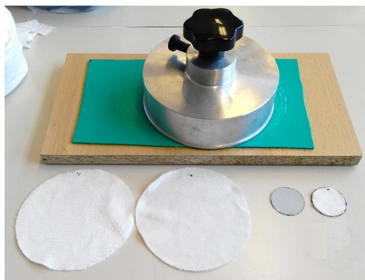
Slika 19. Priprema uzorka za ispitivanje otpornosti na habanje i sklonost pilingu
