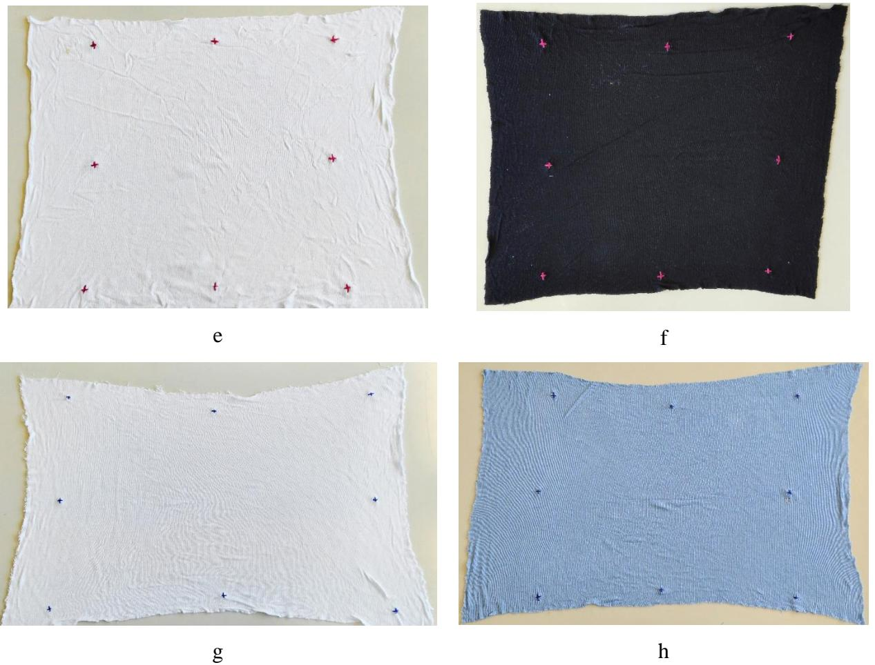
Slika 31. Uzorci za ispitivanje dimenzijske stabilnosti pletiva u raširenom obliku nakon pranja i sušenja: PAM-SIR-P (a), PAM-DOR-P (b), CV-SIR-P (c), CV-DOR-P (d), CV-SIR-R (e), CV-DOR-R (f), CV-SIR-S (g) i CV-DOR-S (h)
