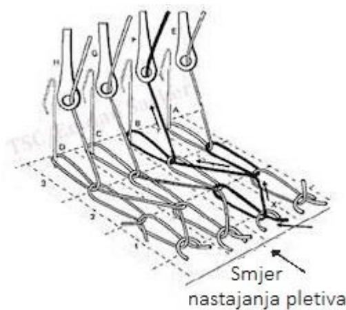
Slika 4. Shematski prikaz izrade lančanih pletiva [5]
