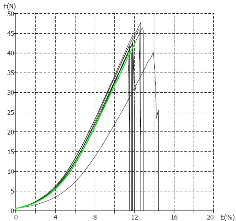
Slika 19. F/E dijagram pojedinačnih vrijednosti mjerena uzorka IČ3
