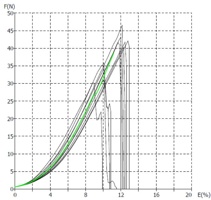
Slika 31. F/E dijagram pojedinačnih vrijednosti mjerena uzorka IČ9
