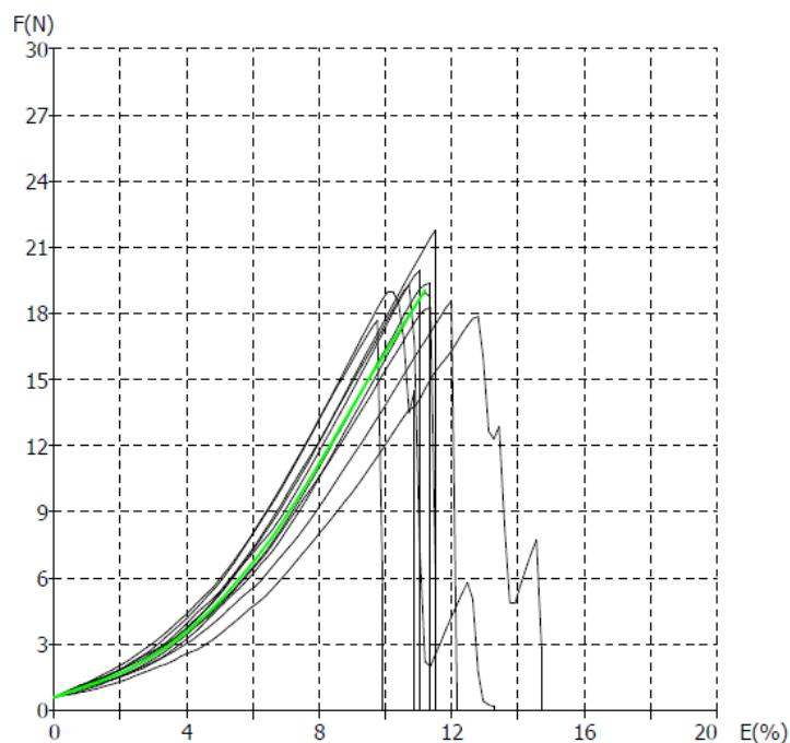
Sl.ika 25. F/E dijagram pojedinačnih vrijednosti mjerena uzorka IČ6
