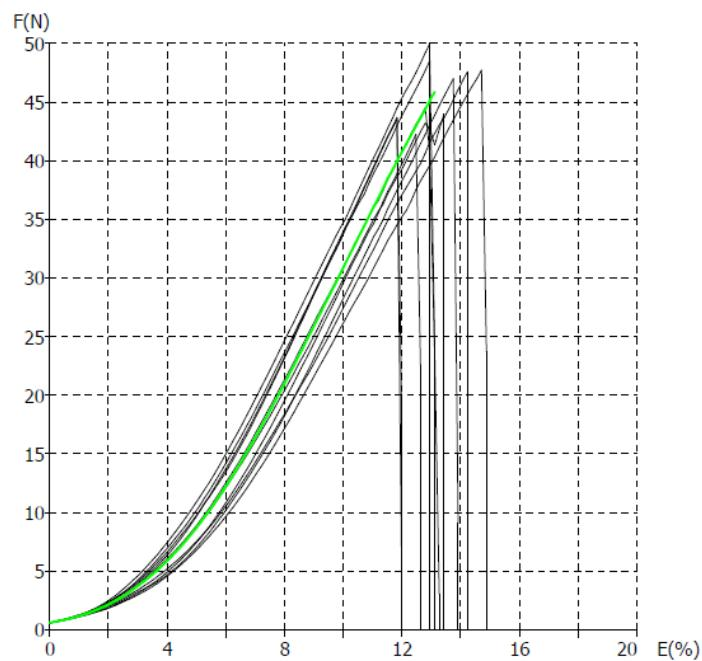
Slika 23. F/E dijagram pojedinačnih vrijednosti mjerena uzorka IČ5
