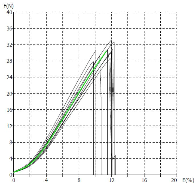
Slika 13. F/E dijagram pojedinačnih vrijednosti mjerena uzorka IČ0
