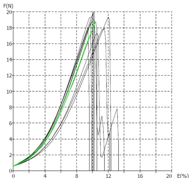
Slika 21. F/E dijagram pojedinačnih vrijednosti mjerjenja uzorka IČ4
