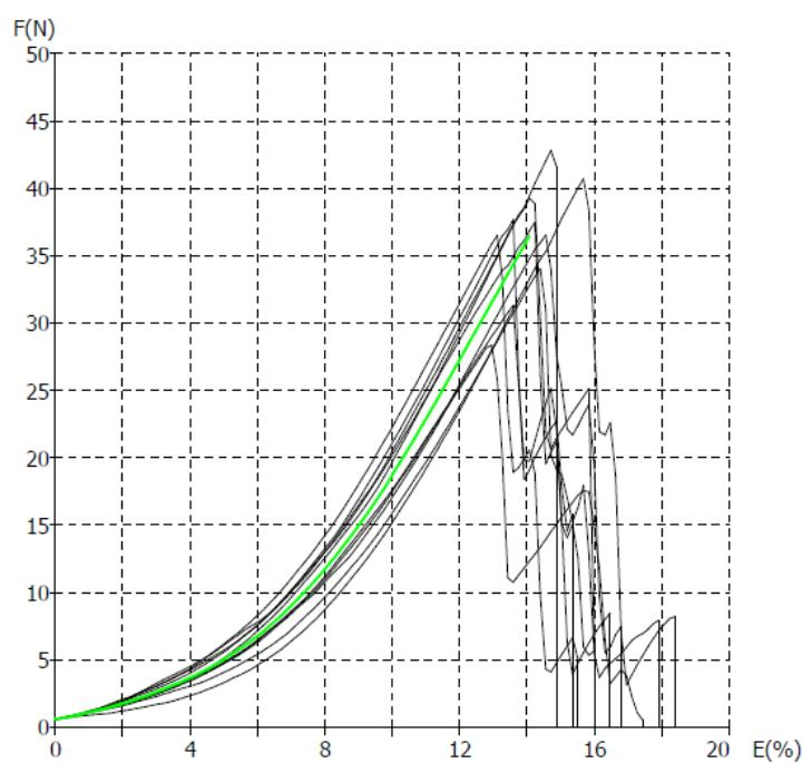
Slika 17. F/E dijagram pojedinačnih vrijednosti mjerjenja uzorka IČ2
