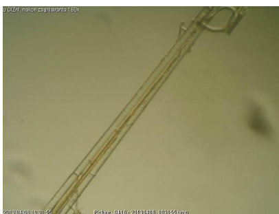
Vlakna zagrijana u ClZnI-reagensu (školski mikroskop, 160x)
