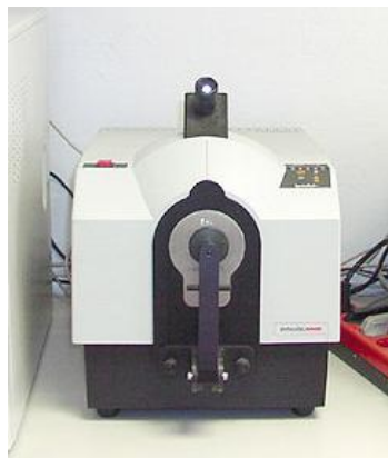
Slika 11 - Remisijski spektrofotometar Spectraflash SF 600 PLUS-CT
