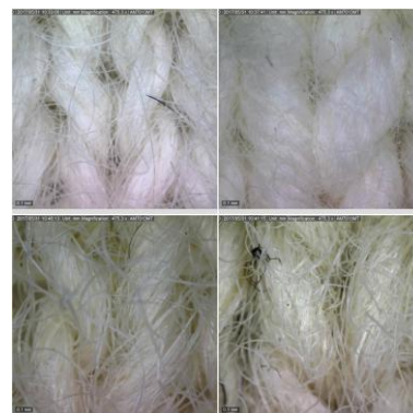
Slika 37. Mikroskopska snimka alpaka i merino pletiva (mikroskop Dino – Lite AM7013)
