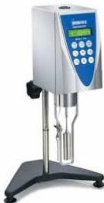
Slika 22. Viskozimetar Brookfield DV II+ [87]
