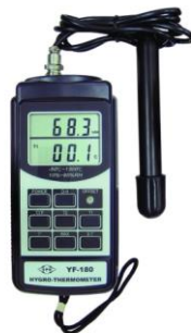
Slika 18. Uređaj za mjerenje temperature i relativne vlažnosti [17]
