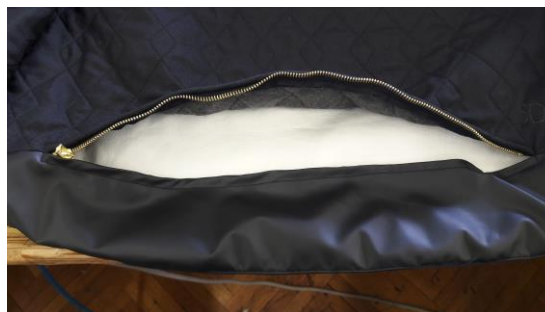
Slika 22. Otvor s patentnim zatvaračem za kontrolu membrane
