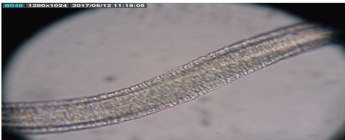
Slika 15. Reakcija poliamida s Frotte I reagensom
