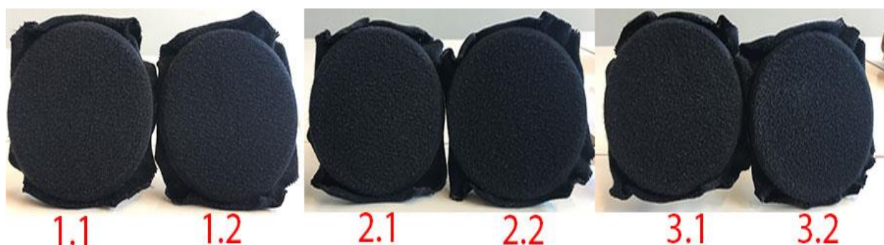
Slika 27. Prikaz rezultata ispitivanja sklonosti pilingu
